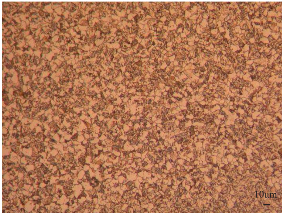
Figura 3.14 Metalografía de material tratado térmicamente a 950°C por 6 horas, a 200X, ataque con Nital al 2% por 10 segundos.
