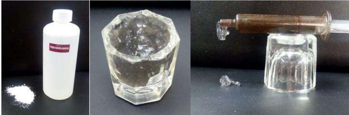
Figura 17: Preparación de gel de Ag-NP y envasado en jeringa.
