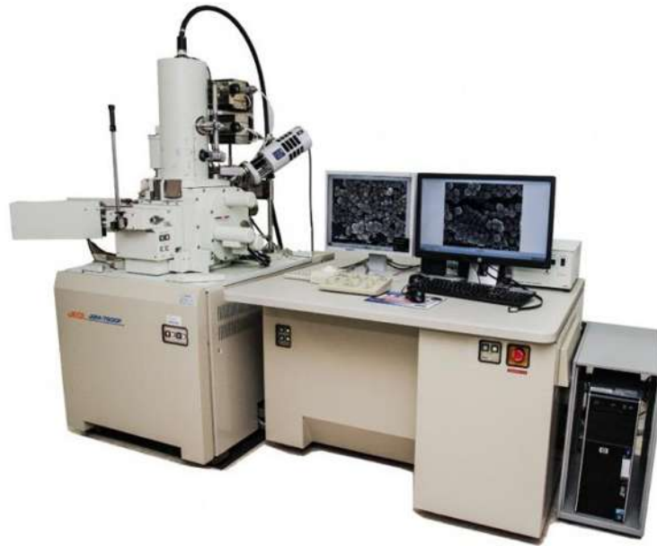
Figura 3.4. Microscopio electrónico de barrido JEOL modelo JSM-7600, Morelia, Michoacán, Méx.
