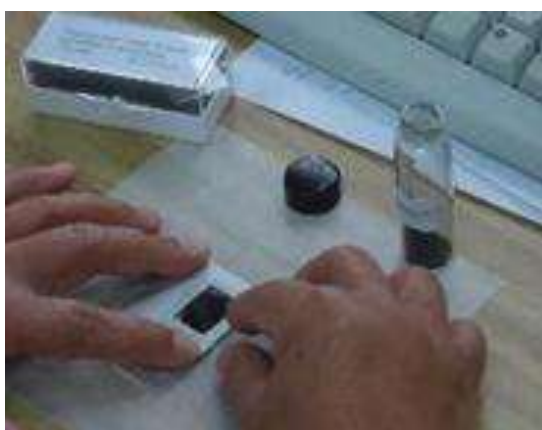
Figura 3.10. Preparación de la muestra para la elaboración del análisis por difracción de rayos X.
