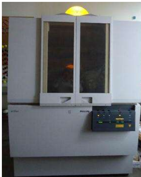
Figura 3.9. Equipo Philips X'Pert empleado para el análisis por rayos X.
