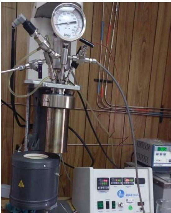
Figura 3.13. Reactor empleado para la evaluación catalítica.
