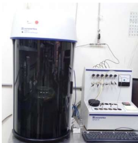
Figura 3.8. Equipo de adsorción TriStar de Micromeritics, empleado para realizar el análisis de área superficial específica y volumen de poros.
