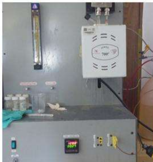
Figura 3.2. Reactor tubular para el Proceso de activación ex-situ , de los precursores catalíticos.
