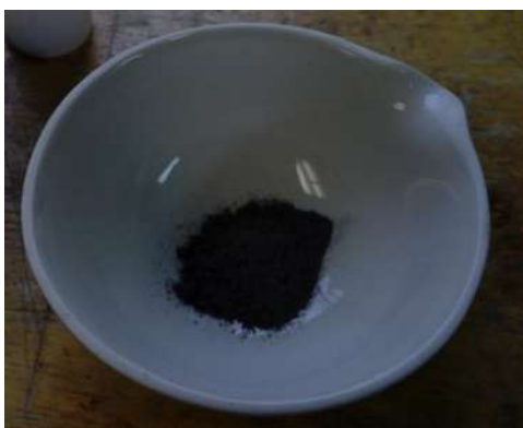
Figura 3.5. Catalizador de CoMoW/Al 2 O 3 base tiosales antes de activar.
