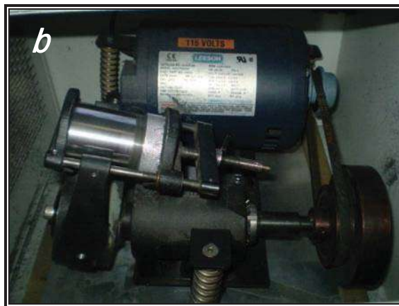
Figura 3.5- Esquema del Contenedor de Molienda(a), Parte Mecánica del Molino de bolas vibratorio de alta energía SPEX 8000 Mixer/Mill(b).
