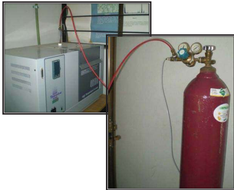
Figura 3.8- Horno adaptado con un flujo de nitrógeno.
