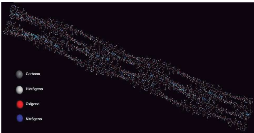
Figura 4.21 Cuatro cadenas de 50 monómeros de QT unidas por puentes de hidrógeno
