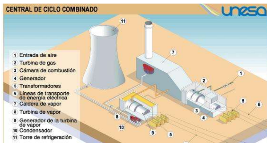
Figura 3. Diagrama de proceso de una central de ciclo combinado.
