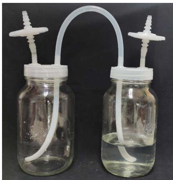
Figura 1. Estructura general de biorreactor de inmersión temporal conformado por dos recipientes gemelos de vidrio, tubos de silicona grado alimenticio y filtros hidrofóbicos.
