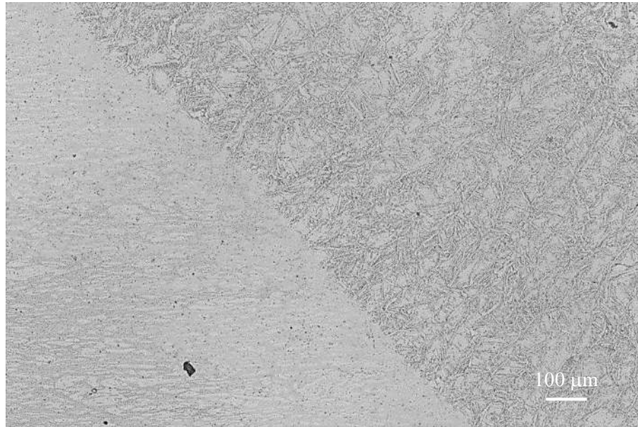
Figura 4.4. Micrografía óptica de la interfase metal base/soldadura.
