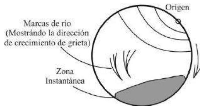
Figura 2.9. Marcas de río en la superficie de las probetas con falla por fatiga [25].
