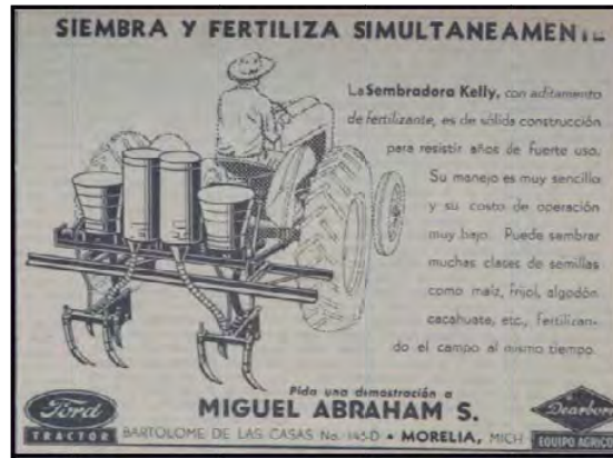
Imagen 1.1. La Sembradora Kelly ahorra tiempo y trabajo, hacia dos acciones a la vez: sembrar y fertilizar. Con ello se dejaban tradicionales formas de sembrar con las manos y fertilizar con botes con orificios *
