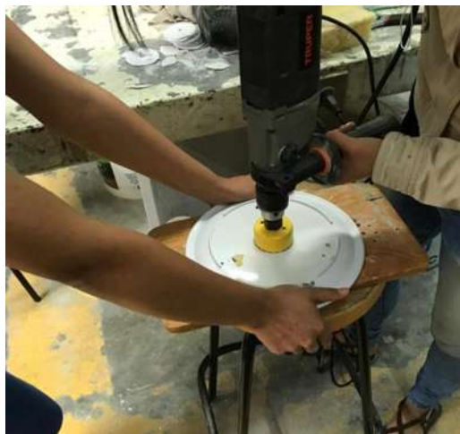
Ilustración 51: Perforación circular al centro del plato, con diámetro de 3"
