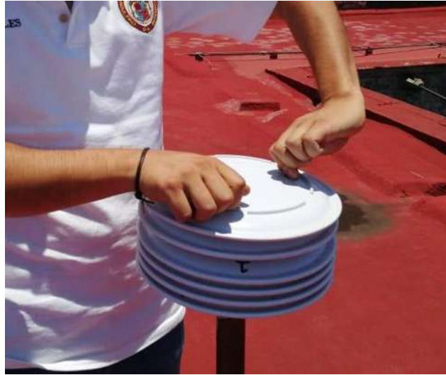
Ilustración 60: Monitoreo de la estación, se giran las mariposas para levantar el plato número 1.
