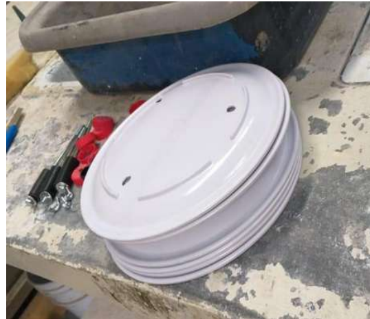
Ilustración 48: a) Perforación de orificios para los tornillos de sujeción, b) Platos de estación perforados para tornillos
