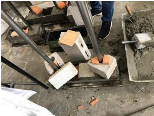
Ilustración 55: Colado de vigas con concreto de 250 \text{ kg/cm}^2
