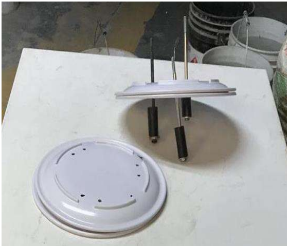
Ilustración 52: Separadores de platos utilizando pedazos de manguera y taparrosas
