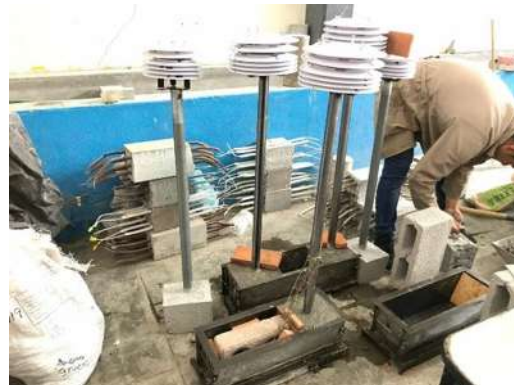
Ilustración 55: Colado de vigas con concreto de 250 \text{ kg/cm}^2
