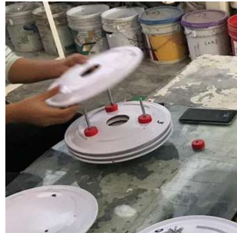
Ilustración 52: Separadores de platos utilizando pedazos de manguera y taparrosas
