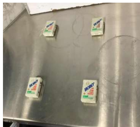
Ilustración 59: Calibración de los sensores, con separación de entre 5 y 10 cm
