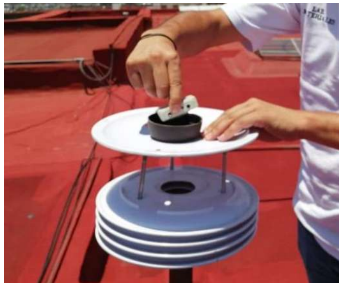
Ilustración 61: Segundo plato en el que se encuentra el HOBO, se retira para su monitoreo
