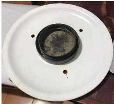
Ilustración 49: Porta-Hobo, con tapa de frasco para protección del equipo
