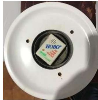
Ilustración 50: Colocación del Hobo en el plato de melamina
