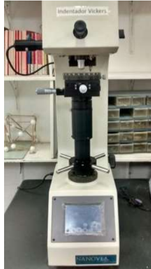
Figura 2.9 Durómetro Vickers marca NANOVEA para dureza y tenacidad a la fractura.
