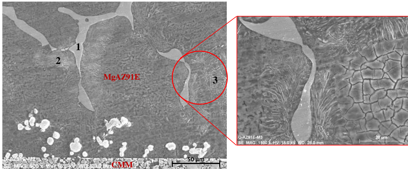
Figura 3.19 Micrografía a 500x de la unión AlN-MgAZ91E/MgAZ91E enfocando la zona donde se aprecia la variada morfología presente en el metal de unión (600 °C a 5horas de permanencia en atmósfera de Ar).
