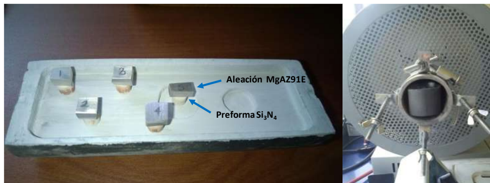
Figura 2.3 3 Acomodo de preformas de AlN con la aleación Mg-AZ91E para el proceso de infiltración.
