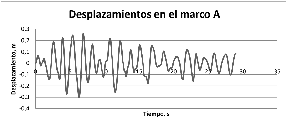
Figura 3.8. Desplazamiento en la historia de tiempo en el extremo del marco A en la junta de dilatación
