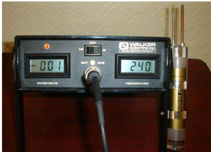
Figura 42.- Equipo Walker Scientific Inc. Alloy Sopperter ATS-6044T para medición del potencial termoeléctrico: técnica de contacto.
