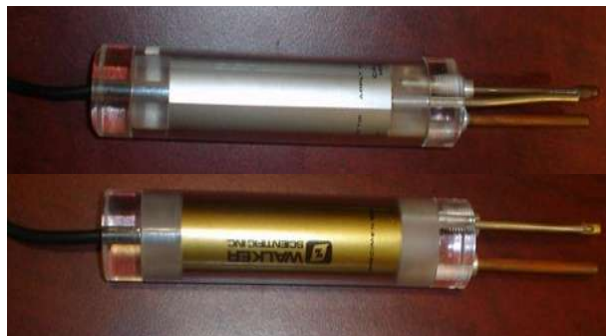
Figura 43.- Puntas de Cu y Au para medición del potencial termoeléctrico, técnica de contacto.
