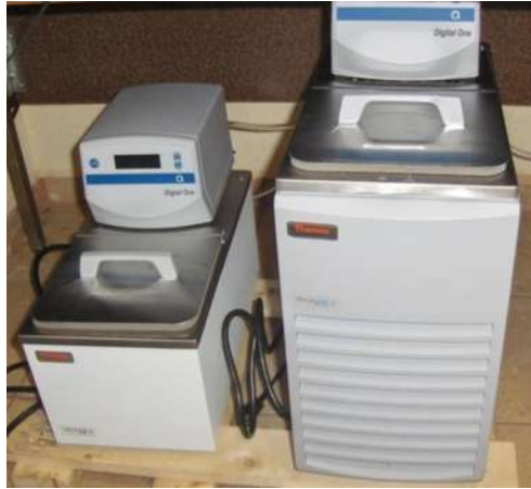
Figura 18.- Unidades de control de temperatura.
