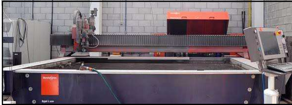
Figura 35.- Equipo empleado para realizar los tratamientos superficiales con chorro de agua.
