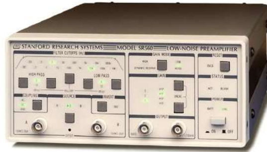
Figura 19.- Filtro (pasa bajas, pasa altas y pasa banda) y acondicionador de la señal.
