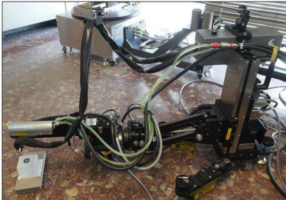
Figura 47.- Difractómetro de rayos-X PROTO-iXRD, CENIM (Madrid, España).
