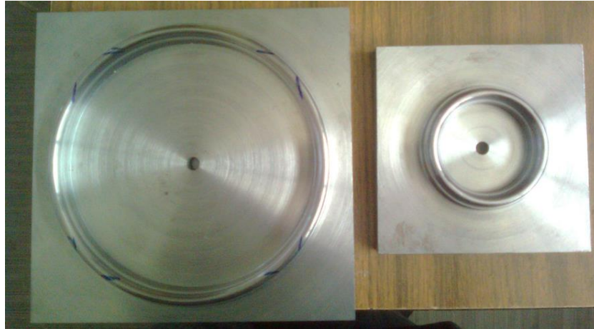
Figura. 6.1 Vista de anillos de reacción (izquierda) y de carga (derecha).
