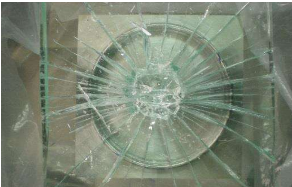
Figura B.8 Patrón de grietas de falla de la muestra 5 de vidrio recocido de 19 mm de espesor. Otros de sus datos son: deflexión = 1.01 mm, carga de falla = 46615.11 N y esfuerzo de falla = 80.03 MPa.
