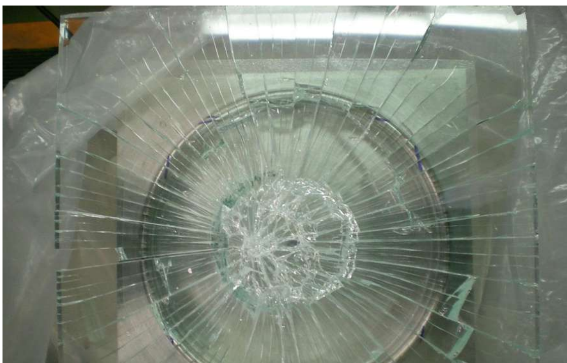
Figura B.5 Patrón de grietas de falla de la muestra 4 de vidrio recocido nuevo de 8 mm de espesor. Otros de sus datos son: deflexión = 0.78 mm, carga de falla = 14121.82 N y esfuerzo de falla = 135.10 MPa.
