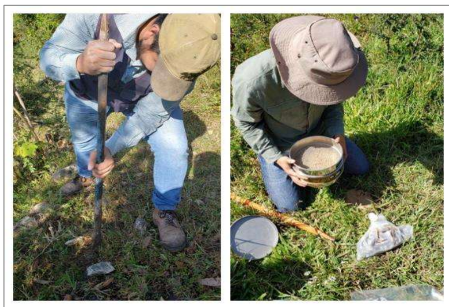
Figura 5.34. Determinación del peso volumétrico en estado natural.
