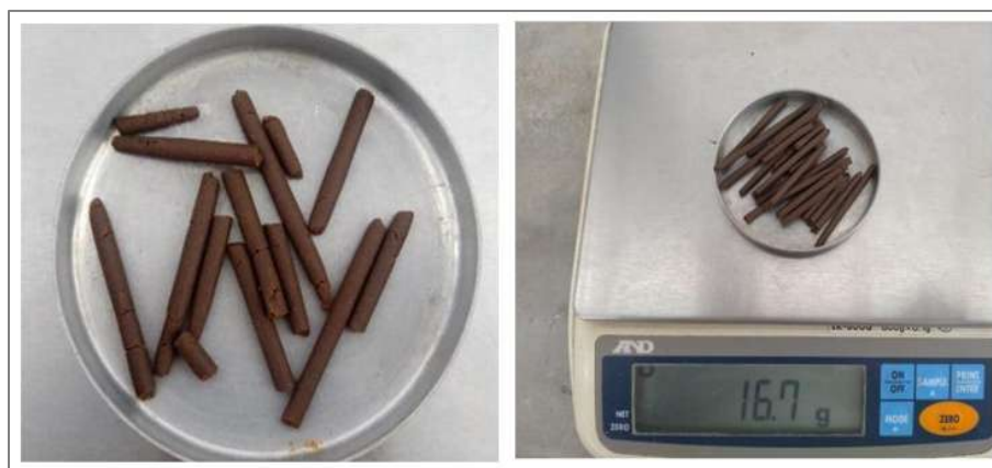
Figura 5.39. Método convencional de rolado para PL.
