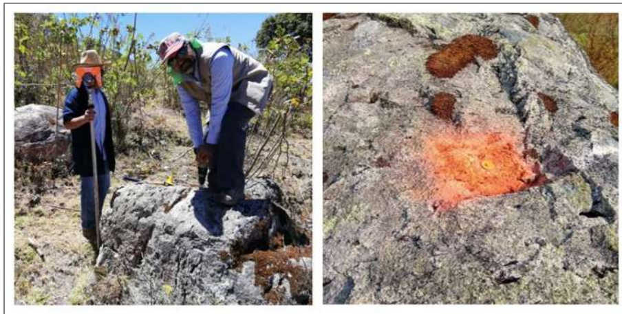
Figura 5.48. Levantamiento de los puntos de control.
