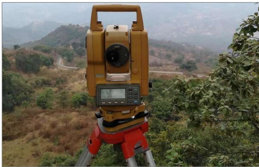
Figura 5.46. Estación total Topcon GTS 235W.
