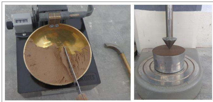
Figura 5.38. Aplicación de la copa de Casagrande y Cono Sueco para LL.
