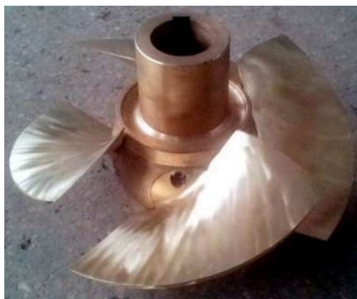
Figura 3.8. Impulsor de diseño de flujo axial [31]
