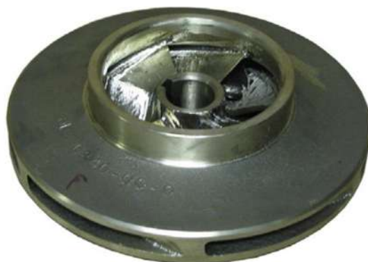
Figura 3.7. Impulsor de diseño cerrado [30]
