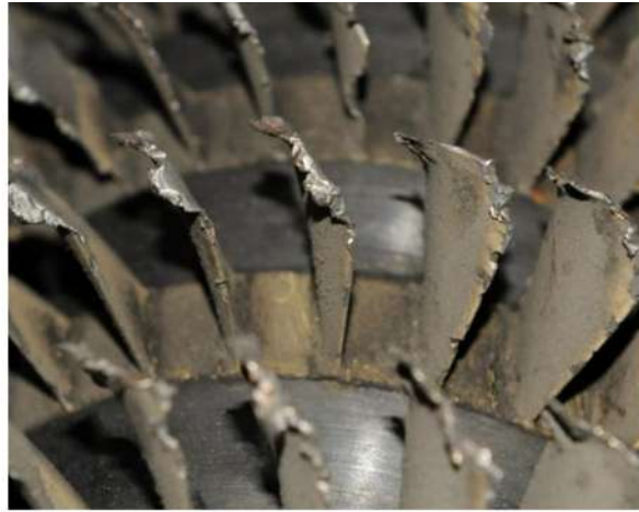
Figura 1.1. Daños en cuerpo de álabe ocasionados por operación [5].
