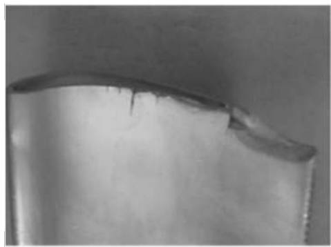
(a) Álabe físico fracturado
