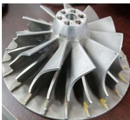
(a) Impulsor físico con álabes fracturados
