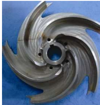
Figura 3.5. Impulsor de diseño abierto [28]
