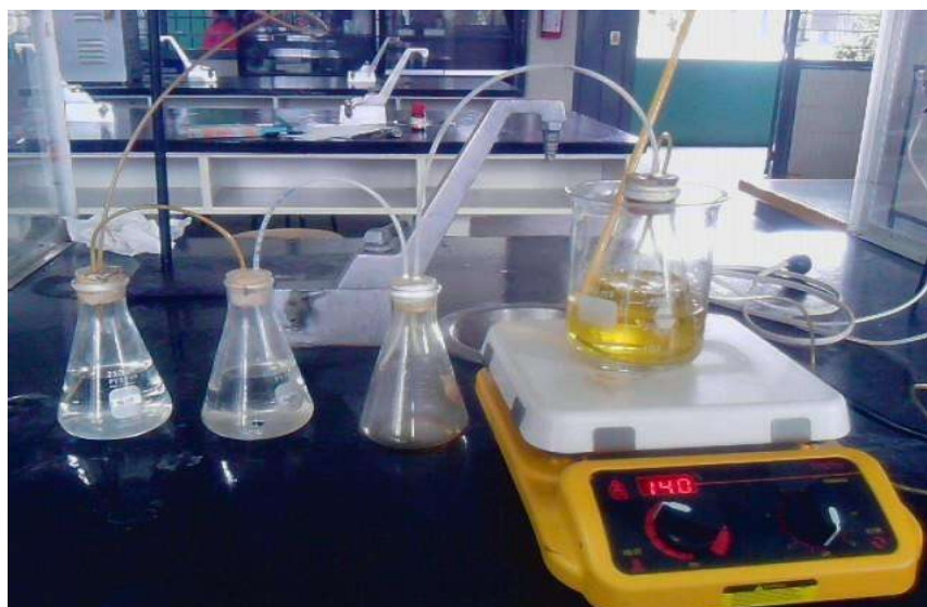
Figura 3.2 Síntesis de tiotungstato de amonio (TTA)
