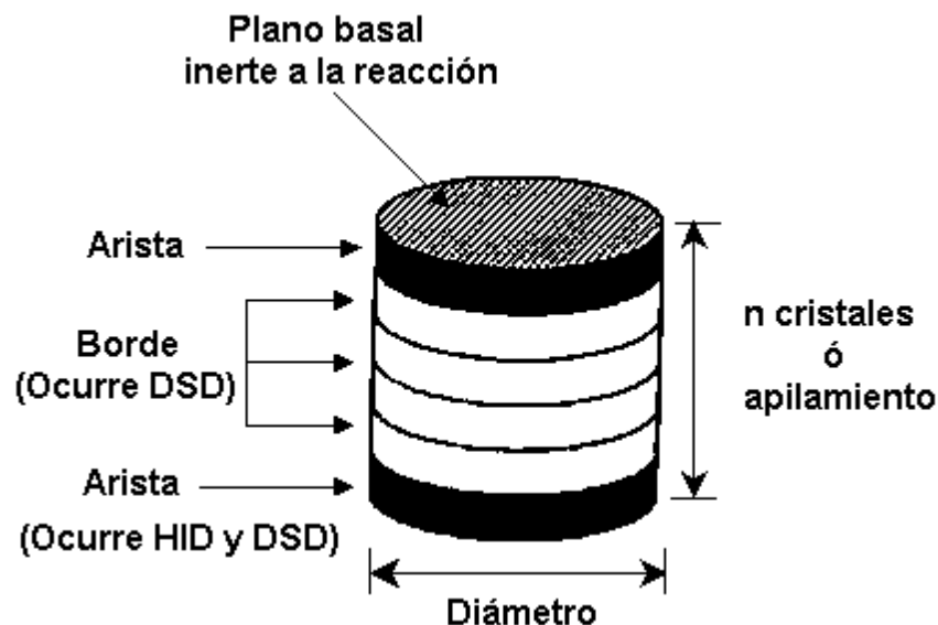
Figura 2.7 Modelo “arista-borde” para sulfuros de metales de transición no promovidos (Tomado de Daage, et al. , 1994).
