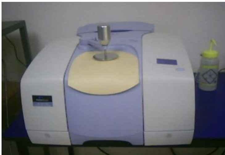
Figura A1.3.- Equipo Espectrómetro Perkin Elmer 400. Donde se realizó el análisis de Espectroscopía de Infrarrojo.
