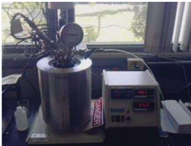
Figura 3.5 Reactor utilizado para la prueba de actividad catalítica
