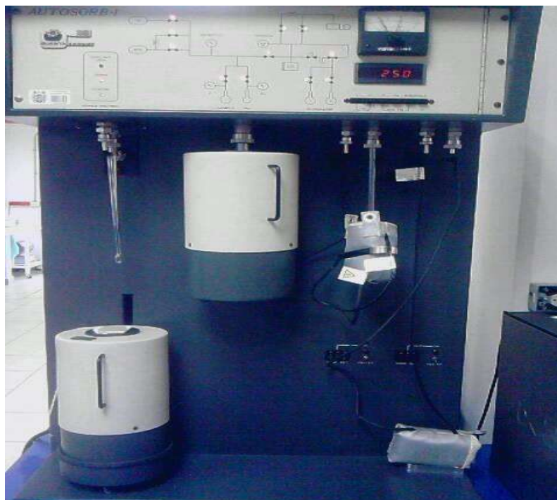
Figura A1.2. Equipo Quadrachrome Autosorb 1. Donde se realizó el análisis de Área superficial específica y tamaño de poro
