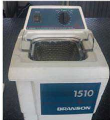
Figura 2.12 Limpiador ultrasónico Branson 1510 utilizado para eliminar impurezas en los aceros TWIP.
