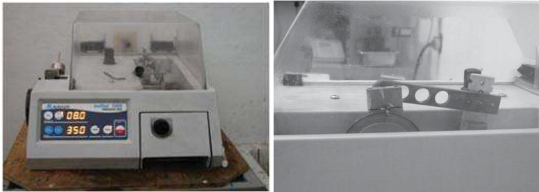
Figura 2.11 Cortadora ISOMET 1000 marca BUEHLER utilizada para el corte de probetas de los aceros TWIP.
