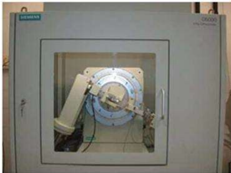
Figura 2.14 Difractómetro Siemens D5000® empleado para los ensayos de difracción de Rayos-X.
