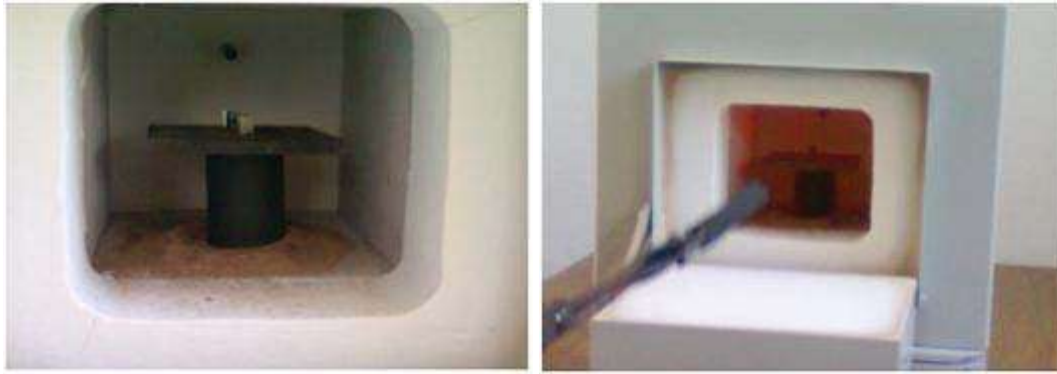
Figura 2.9 Acomodo de las probetas dentro de la mufla de laboratorio.
