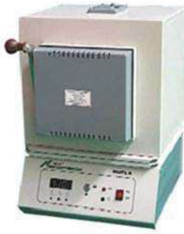
Figura 2.7 Mufla programable para realización del tratamiento térmico de recristalización estática a 650 y 750°C.
