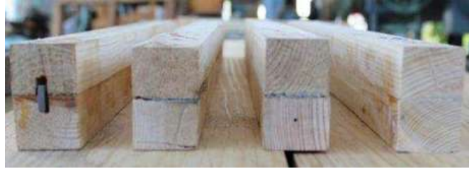
Figura 42 Muestras de la etapa 1, T-1 con solera, b) T-2 con malla galvanizada, c) T-3 con malla metálica y d) T4 madera-madera.
