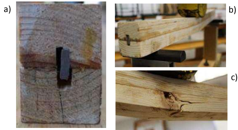
Figura 75 a) pieza de madera compuesta con solera en ensayo mecánico, b) pieza sometida a flexión, c) falla de la pieza de madera por presencia de nudo.
