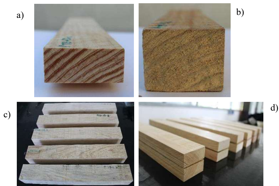
Figura 24 T-a: madera maciza 2 x 4 x 35 cm, T-b: madera maciza 4 x 4 x 35 cm T-c: listones de madera adheridos con pegamento dimensión total 4 x 4 x 35 cm, T-d: piezas combinadas de madera adheridas con pegamento y alma de malla metálica dimensión total 4 x 4 x 35 cm.
