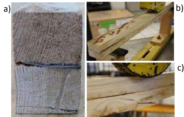
Figura 76 a) pieza de madera compuesta con alma de lámina galvanizada, b) pieza sometida a flexión, c) falla de la pieza en la lámina inferior.
