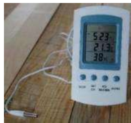
Figura 35 Medidor de humedad precisión de temperatura de \pm 1^{\circ}\text{C} y de humedad de \pm 5\% RH.
