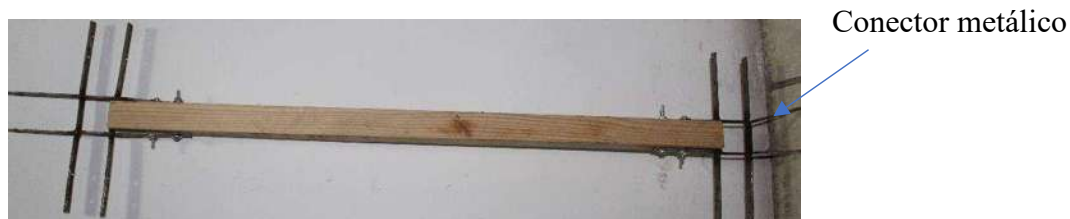
Figura 30 Pieza de madera solida con conector metálico.
