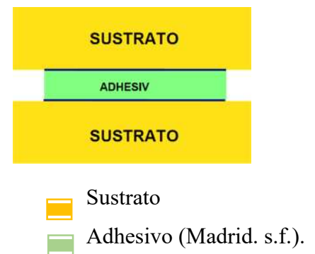
Figura 14 Esquema de la unión adhesiva
