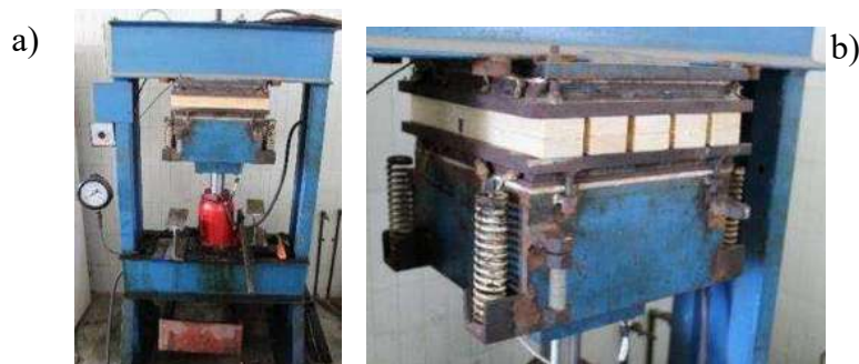
Figura 37 a: prensa hidráulica, b: presando de piezas de madera.
