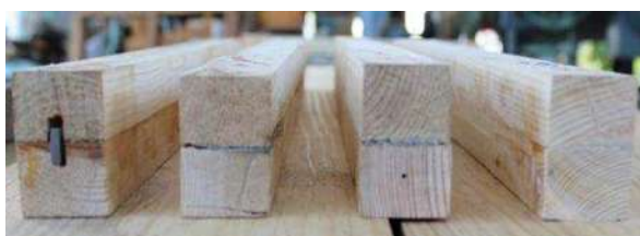
Figura 19 Muestras de la etapa 1, a) T1 con solera, b) T2 . con malla galvanizada, c) T3 . con malla metálica y d) T4 . madera-madera.
