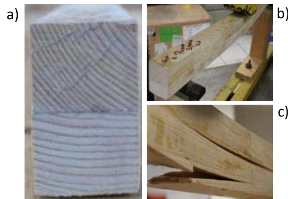
Figura 77 a) piezas de madera solida pegadas con resina epoxica, a) pieza sometida a flexión, c) falla de la pieza.
