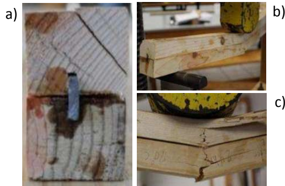
Figura 78 a) pieza de madera compuesta con solera metálica, b) pieza sometida a flexión, c) falla de la pieza de madera.
