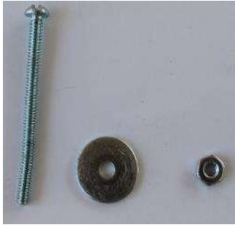
Figura 31 Conector metálico: a) conector metálico en forma de cruz griega, b) tornillo de 2.5” de longitud, rondana de 19 mm y tuerca de forma hexagonal de 8 mm.
