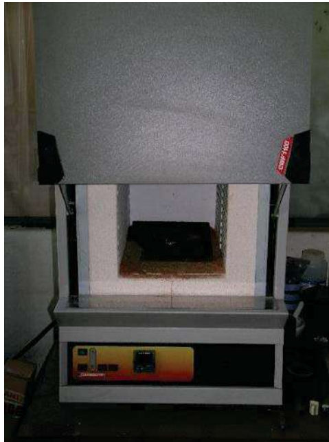
Figura 3.6 Horno Carbolite CWF 1100.
