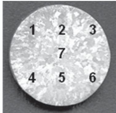
Figura 3.13 Esquema del arreglo en que se efectuaron las indentaciones a las probetas (25 mm de diámetro y 10 mm de espesor) ensayadas y forma de la probeta para los ensayos de dureza.
