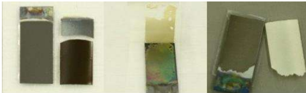
Figura 2.1. Placas de Titanio anodizadas para mejorar sus propiedades mecánicas
