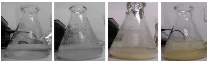
Figura 3.11 Disolución del quitosano en ácido acético (CS/AC) por no presentar precipitados.
