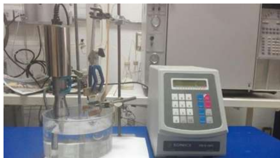
Figura 3.9 Sonicador empleando para el desprendimiento de los NTT.
