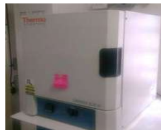
Figura 3.7 Mufla donde se realizó el tratamiento a las placas de titanio
