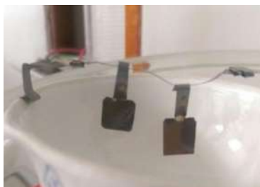
Figura 3.6 Placas anodizadas en seco, antes del templado
