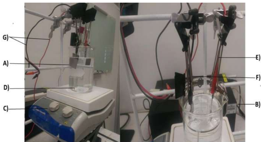
Figura 2.9 Dispositivo experimental para anodización de las muestras: (a) celda electroquímica, (b) fuente de alimentación, (c) control de temperatura, (d) sistema de agitación, (e) ánodo, (f) cátodo, (g) contactos eléctricos del ánodo y cátodo.
