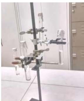
Figura. 3.13 Separación de fases de la solución de quitosano en disolventes polares.
