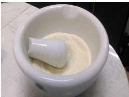
Figura 3.10 Quitosano en polvo después de varias horas de molienda.
