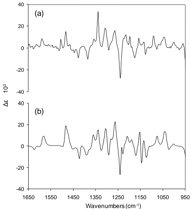
Figura 21. a) Espectro DCV experimental, b) Espectro de DCV DFT B3LYP/DGDZVP de la deoxipodofilotoxina 29 .
