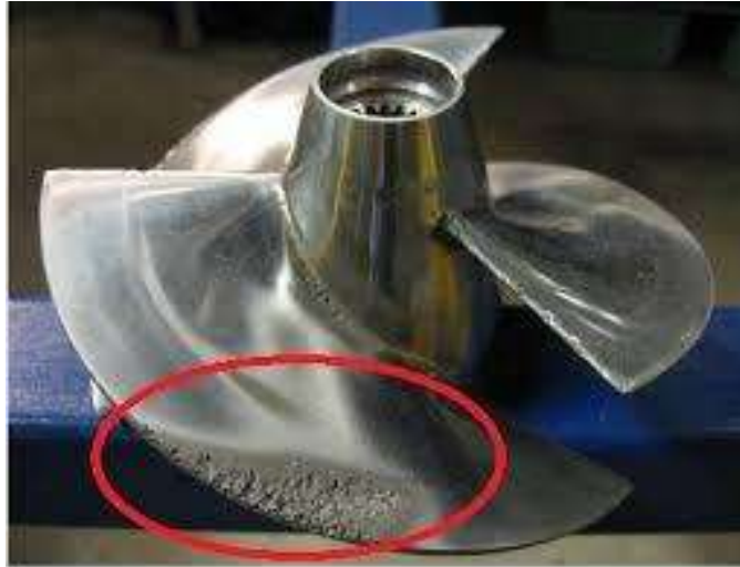
Figura 3.6. Corrosion por Cavitacion. Fuente: https://ingenieriamecanicacol.blogspot.com/2016/07/corrosion-por-cavitacion.html .
