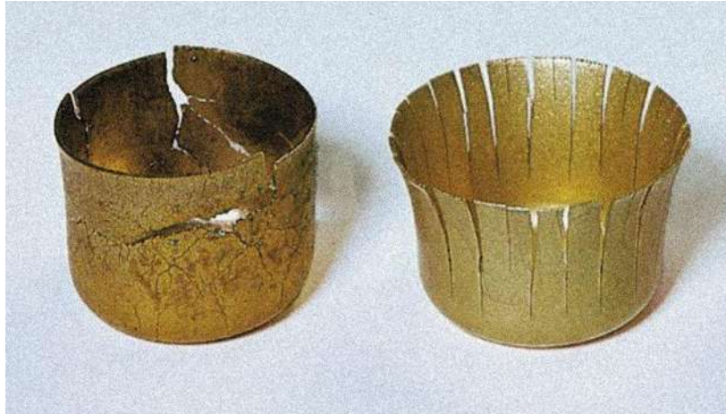
Figura 3.7. Corrosión por fisura. Fuente: https://corrosioncarlos.files.wordpress.com/2015/07/agrietamiento.jpg .
