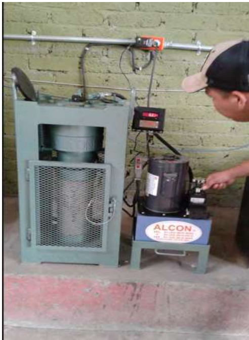
Prensa de Compresión Axial
