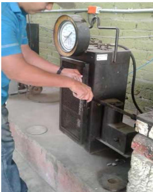
Pruebas en laboratorio en la prensa para concretos
