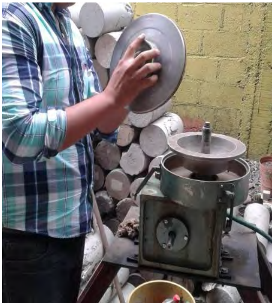
Máquina para lavado de mezclas asfálticas
