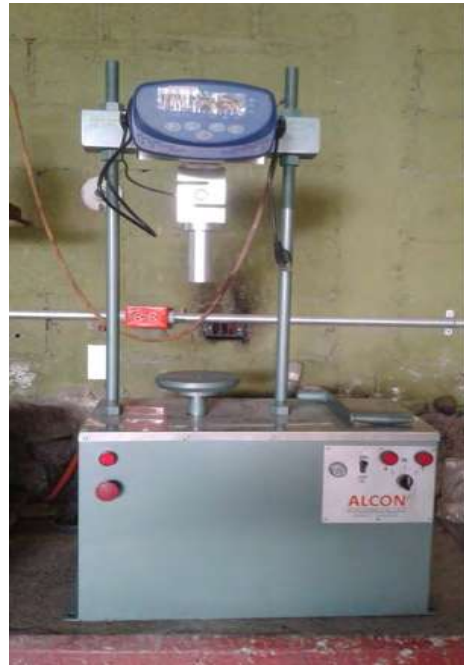
Prensa para pruebas Marshall
