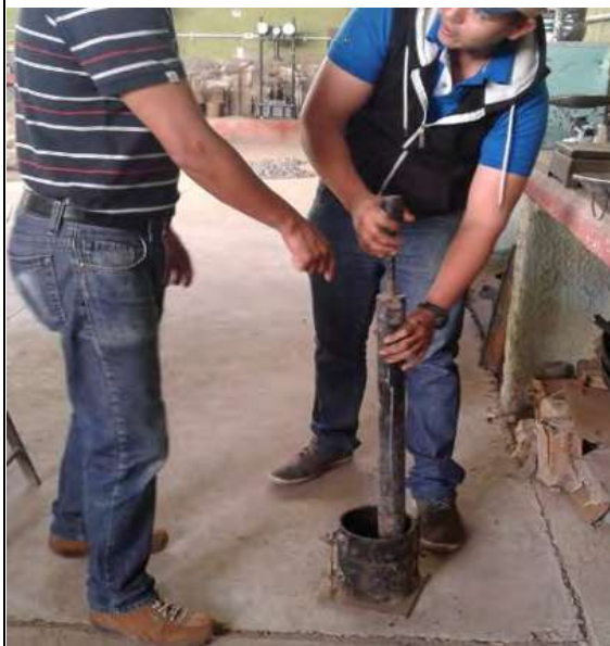
Compactando material en molde
