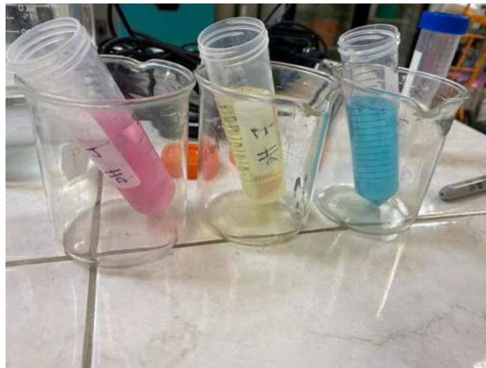
Figura 22. Soluciones buffer de pH 4, 7 y 10, empleadas para la calibración del sensor de pH, elaboración propia.
