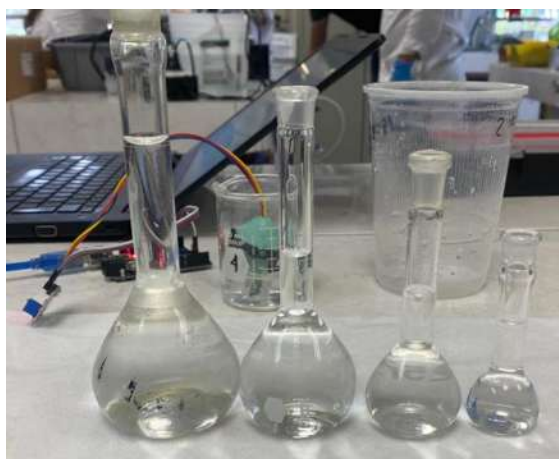
Figura 26. Diluciones de 5, 10, 20 y 50 NTU, preparadas para la calibración del sensor de turbidez.
