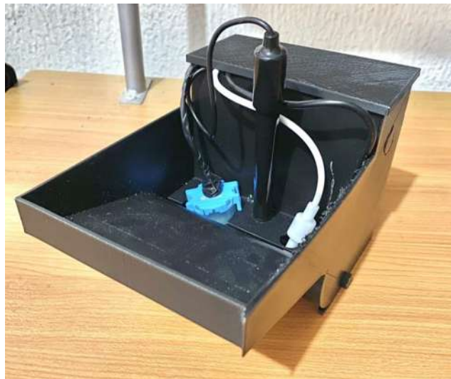
Figura 20. Modelo 3D donde se integran los circuitos de los sensores de calidad del agua de lluvia.
