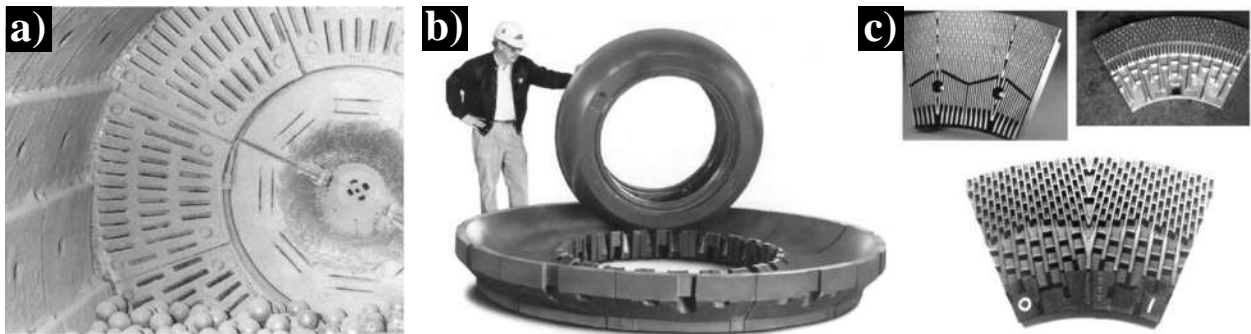
Figura 2.10 Aplicación de aleaciones de hierro blanco alto cromo. a) molinos de cemento (industria cementera), b) pulverizadora de carbón (industria de la minería) y c) segmentos de placas refinadoras (industria del papel) [7].
