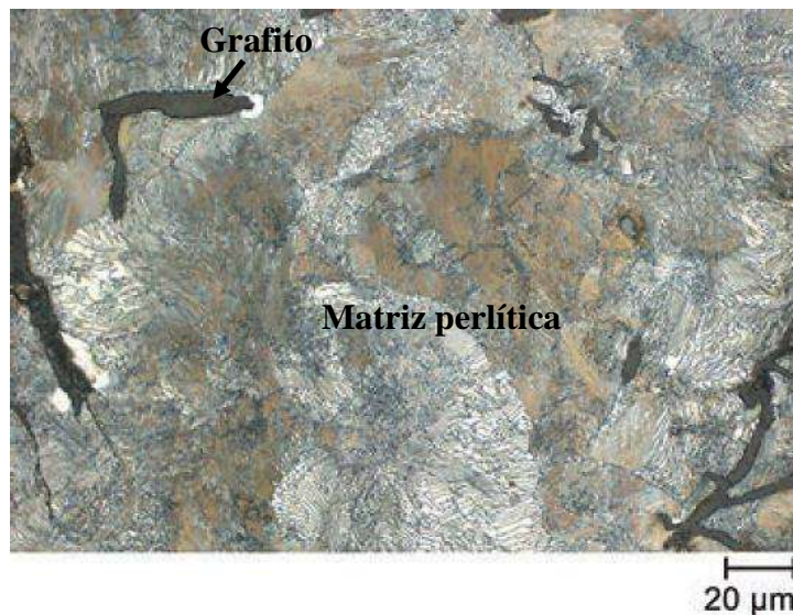
Figura 2.4 Microestructura de un hierro perlítico gris atacado con picral al 4 % [36].
