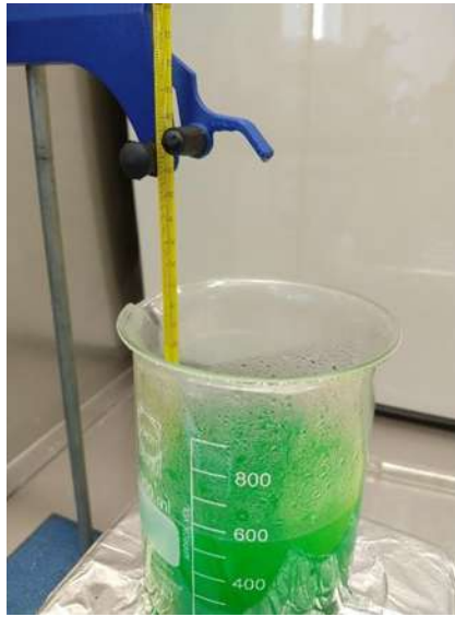
Figura 3.10 Baño niquelado químico realizado a las aleaciones experimentales.
