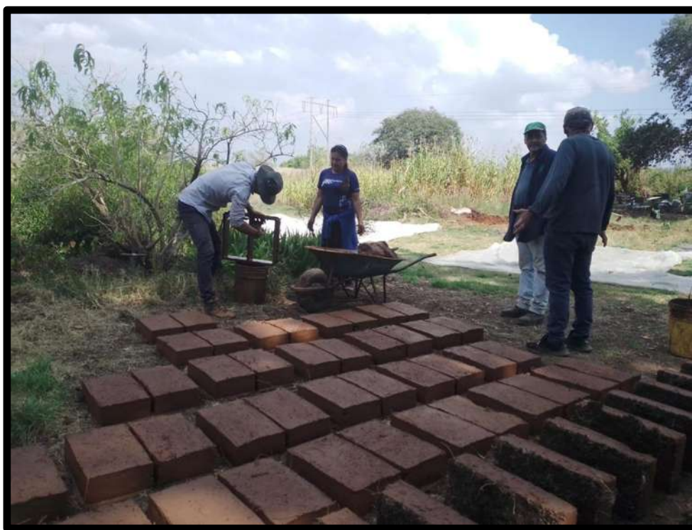
Figura 35. Proceso de secado del adobe
