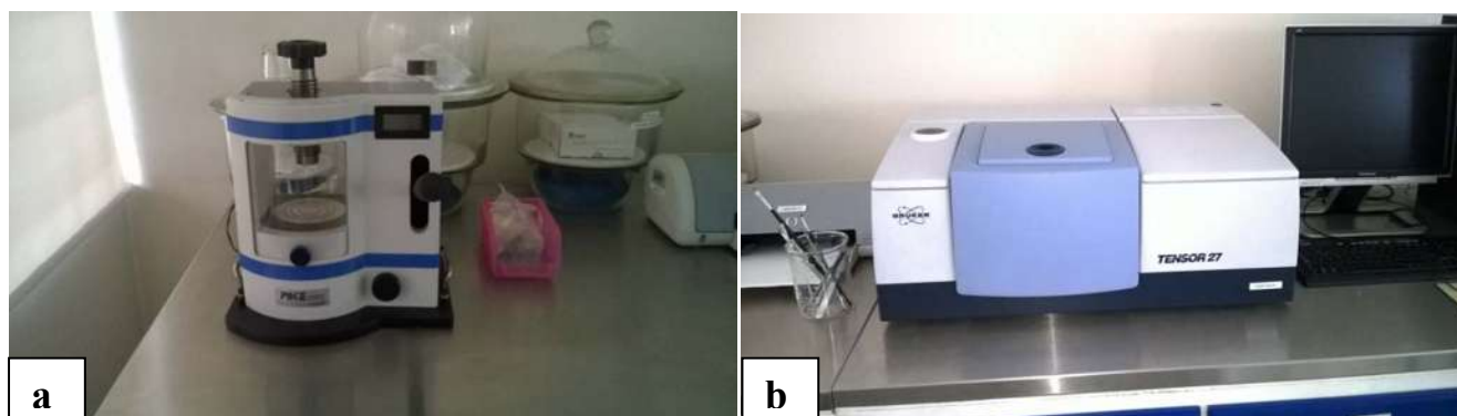
Figura 31. a) Prensa para generar pastillas y b) Espectrómetro de infrarrojo BRUKER.
