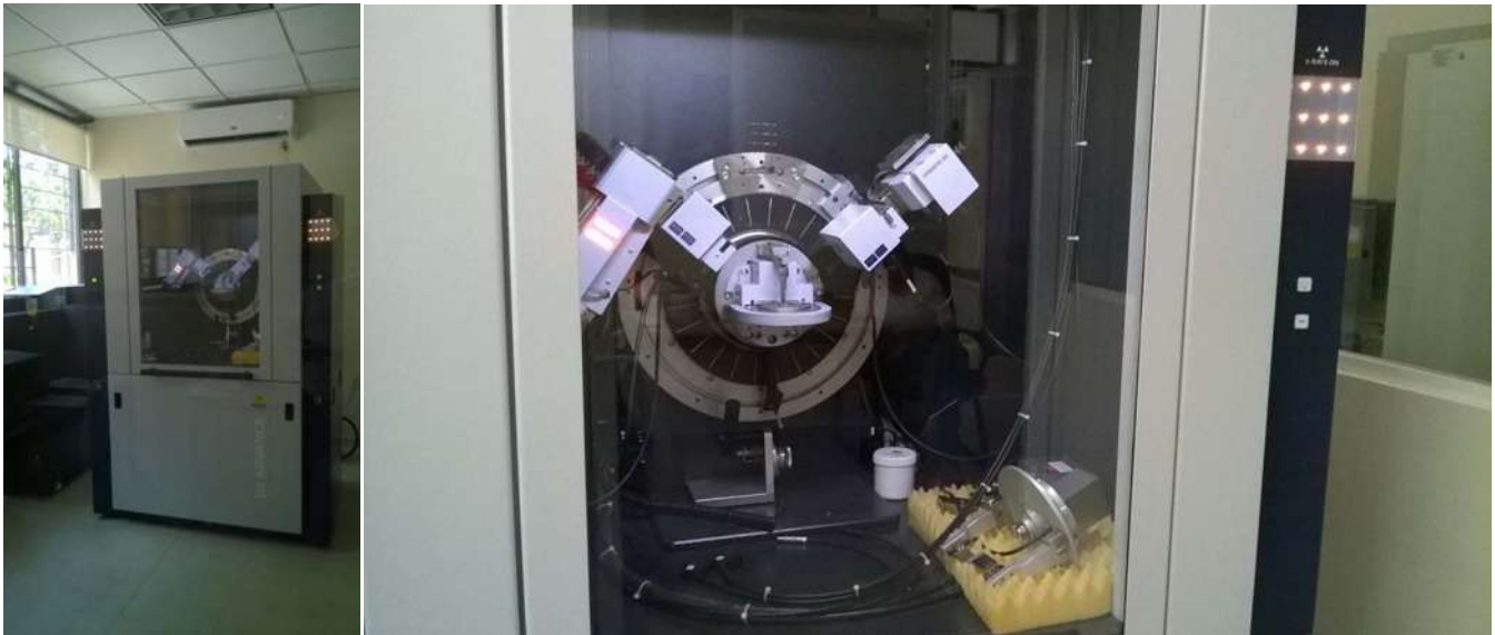
Figura 30. Difractómetro de rayos X D8 ADVANCED, identifica minerales y sus diferentes fases.
