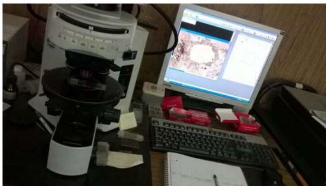
Figura 35. Microscopio petrográfico, observación de láminas delgadas.
