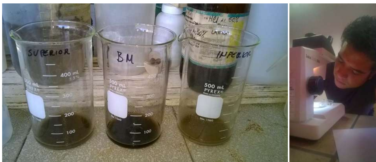
Figura 34. a) Limpieza de las macropartículas de carbón, b) conteos en lupa estereoscópica.
