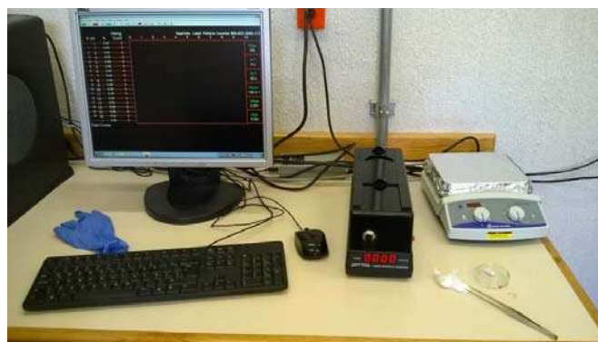
Figura 27. Analizador de partículas finas SPECTREX LASER.
