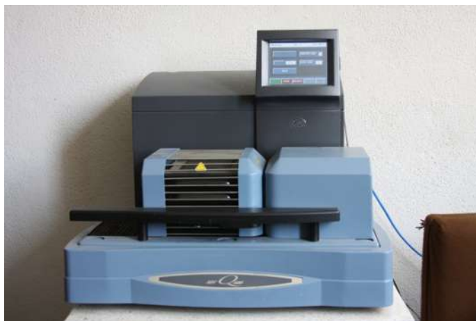
Figura 2.22 Equipo de análisis termogravimétrico marca TA Instruments modelo SDT Q 600.
