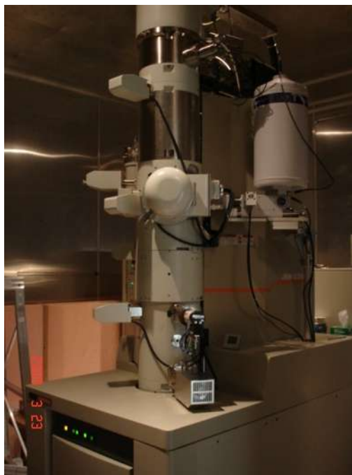
Figura 2.18 Microscopio electrónico de transmisión marca Jeol modelo JEM-2200FS.
