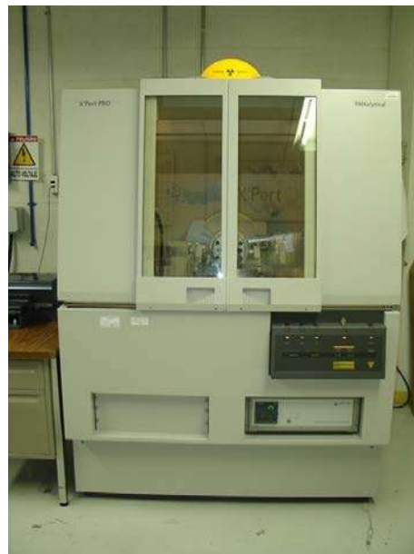
Figura 2.20 Difractómetro de rayos X marca Panalytical modelo Xpert'PRO.
