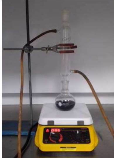
Figura 3.4 Etapa de funcionalización de los NTC: reflujo de NTC en medio ácido.
