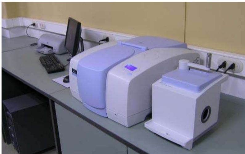
Figura 2.27 Espectrógrafo Infrarrojo SPECTRUM 100 FT-IR.
