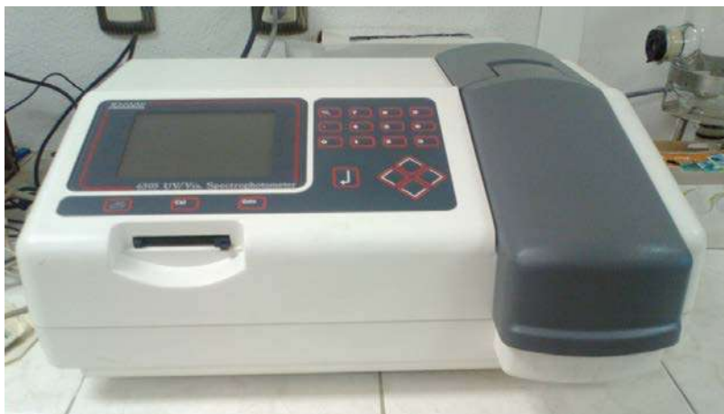
Figura 2.30 Espectrofotómetro marca Jenway modelo 6505.
