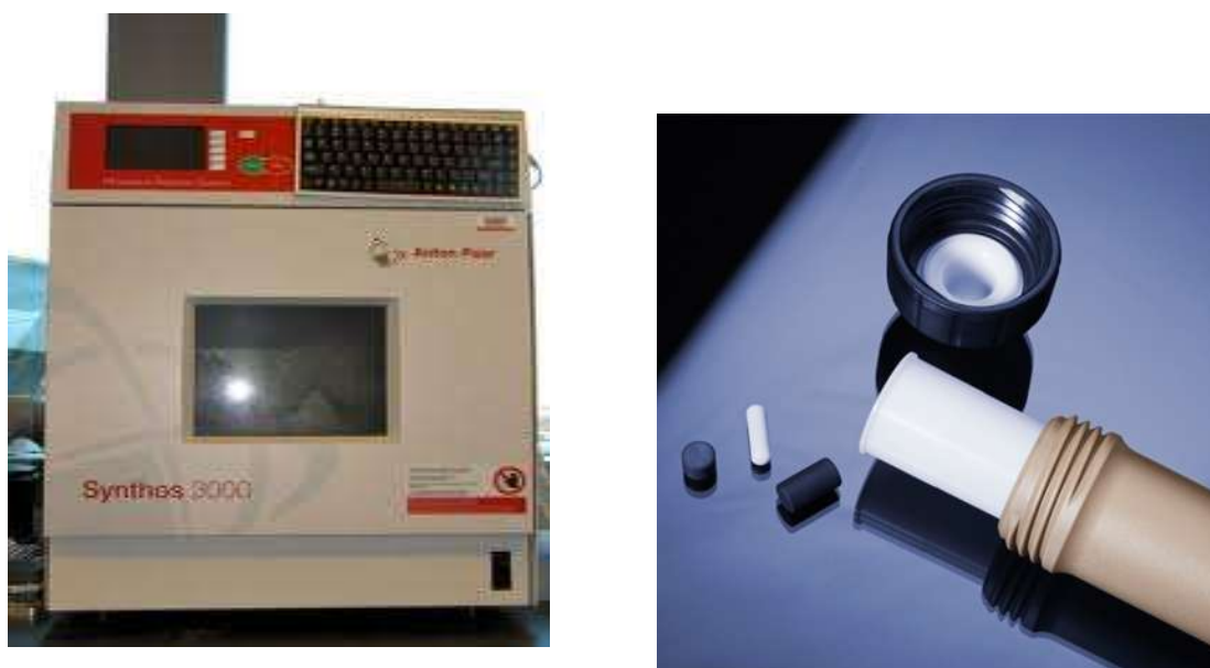
Figura 3.6 Equipo marca Anton Parr modelo Synthos 3000 utilizado para la síntesis de nanopartículas metálicas sobre NTC por el método asistido por microondas.
