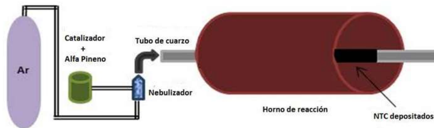
Figura 2.8 Diagrama del método de rocío pirolítico.
