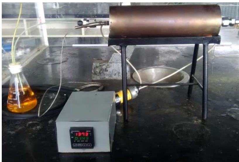
Figura 22 Sistema de calcinación y activación.
