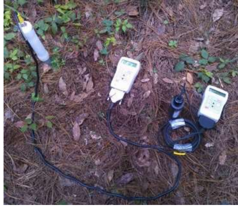
Figura 9. Sondas TDR DELTA-T PR2 (Izquierda) y ML2 (Derecha) instaladas para realizar mediciones en campo.
