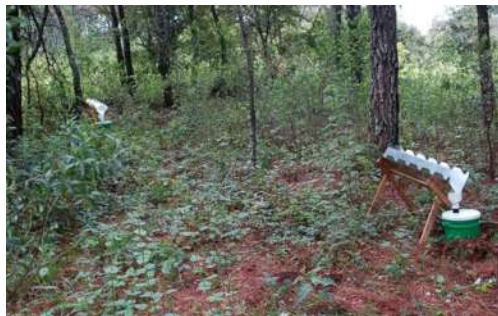
Figura 6. Canaletas metálicas para medir la precipitación efectiva ( P_d ).
