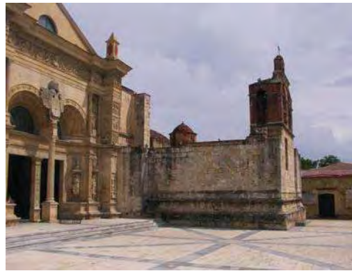
Foto 84. Campanario inconcluso sobre el cual se construyó una espadaña.
