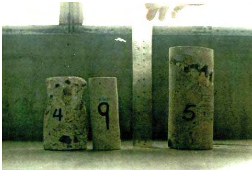
Foto 222. Muestras del material de las columnas de la Catedral. Tomadas por el Ing. Ricart Nouel para realizar el estudio de materiales. Fuente: Oficina de la Obra y Museos de la Catedral.
