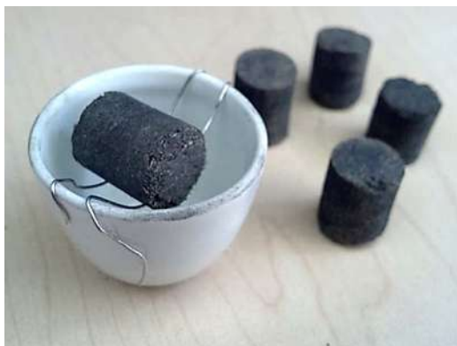
Figura 3.8. Briquetas compuestas de biomasa y mineral de hierro antes de la reducción.
