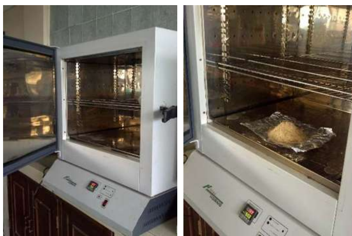
Figura 3.3. Horno Felisa empleado para remoción de la humedad en el bagazo de agave.
