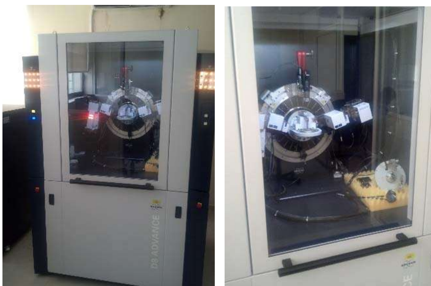
Figura 3.5. Difractómetro de Rayos X D8 ADVANCE DAVINCI (Bruker).
