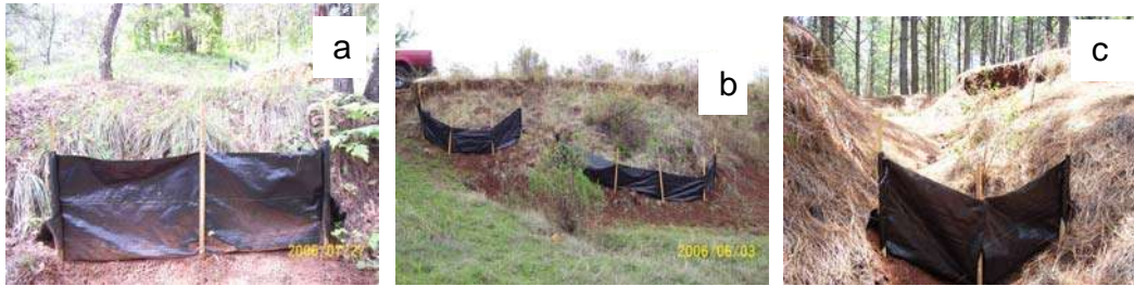
Figura 5.2.1. Trampas de sedimentos colocadas en las tres partes que componen una cárcava: a) cabecera, en esta caso cubierta por bosque de pino, b) talúd cubierto por pastizal y c) fondo cubierto por mantillo, bajo una reforestación de pino de 30 años de edad.
