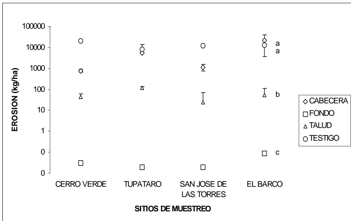
Figura 5.2.3. Erosión en las tres partes de las cárcavas con cobertura vegetal en la cuenca de Cuitzeo, Michoacán. Las barras de error representan \pm 1 desviación estándar. Las letras a, b y c, representan igualdad o diferencia estadística ( \alpha=0.05 ).
