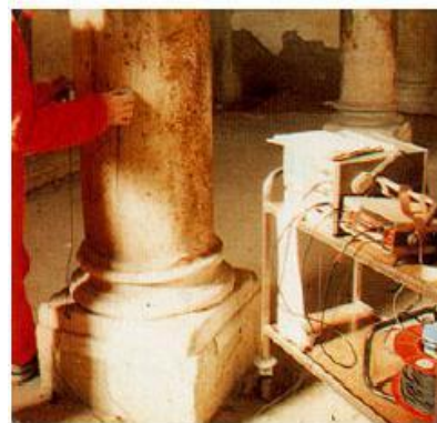
Imagen 51 pruebas ultrasónicas fuente: Técnicas de diagnóstico y monitoreo estructural, Guillermo Martínez.
