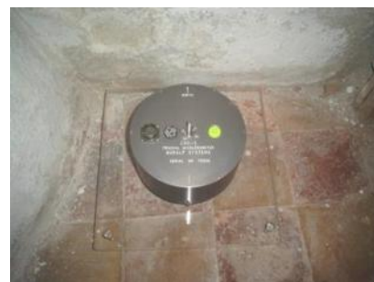
Imagen 50 Sensor acelerométrico sobre placa de metacrilato. Fuente: Técnicas de diagnóstico y monitoreo estructural, Guillermo Martínez.
