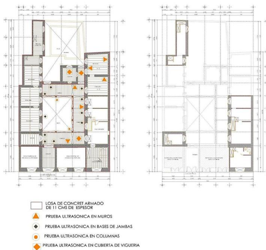
Imagen 52 Plano de pruebas ultrasónicas, elaborado por la autora.
