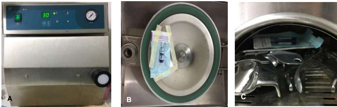
Figura 26. A) Autoclave "MDC Dental" a 121°C con 20 minutos de esterilización y 30 min de secado. B) Ampolleta 1 Puerta. C) Ampolleta 2 Atrás.
