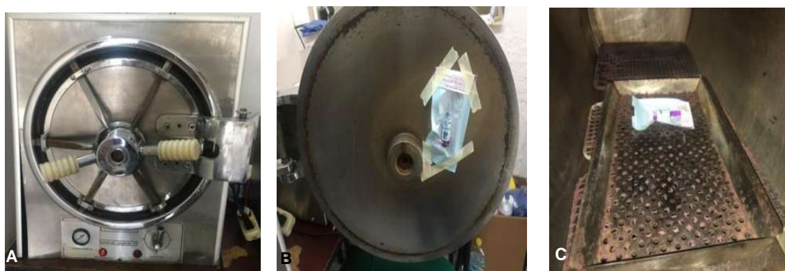
Figura 18. A) Autoclave sin marca a 130°C con 20 minutos de esterilización y 20 min de secado. B) Ampolleta 1 Puerta. C) Ampolleta 2 Atrás.
