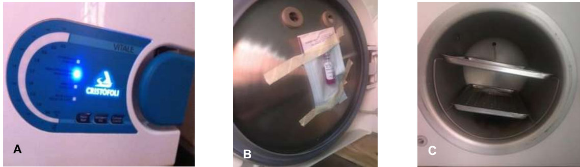
Figura 19. A) Autoclave Cristófoli, modelo "vitale" a 130°C con 20 minutos de esterilización y 30 min de secado. B) Ampolleta 1 Puerta. C) Ampolleta 2 Atrás.
