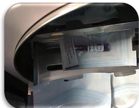
Figura 4. Se colocó la ampolleta número 2 en la parte posterior de la autoclave.
