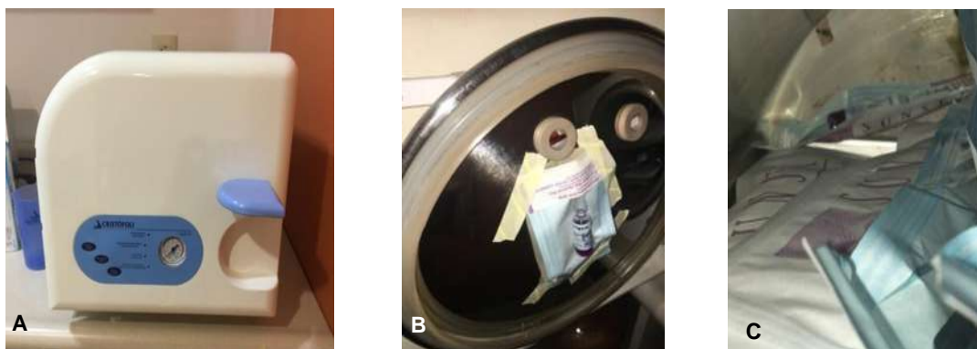
Figura 16. A) Autoclave Cristófoli, modelo "vital 12", 130°C con 20 minutos de esterilización y 30 min de secado. B) Ampolleta 1 Puerta. C) Ampolleta 2 Atrás.
