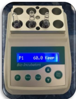
Figura 10. Las ampollas que fueron sometidas al ciclo de esterilización, junto con el control positivo, se depositaron en una incubadora automática Bio-Incubators a una temperatura de 60°C durante 72 horas.
