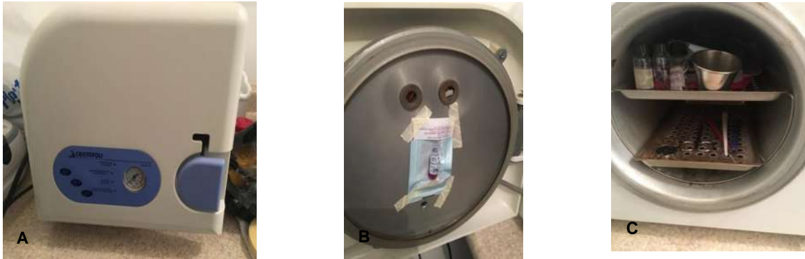
Figura 34. Autoclave Cristófoli, modelo "vitale12" a 130°C con 20 minutos de esterilización y 30 min de secado. B) Ampolleta 1 Puerta. C) Ampolleta 2 Atrás.
