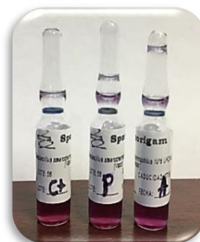
Figura 9. Como control positivo se utilizó una ampolleta que no paso por el ciclo de esterilización.
