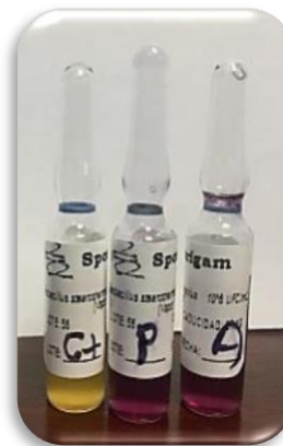
Figura 11. La ampollita de control positivo debe mostrar un viraje de color violeta al amarillo y turbidez. Si las demás ampollitas no cambian de color significa que la esterilización fue exitosa.
