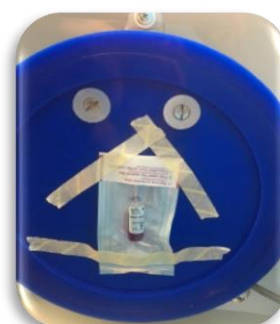
Figura 3. Se colocó la ampolleta número 1 en la puerta con ayuda de la cinta testigo.
