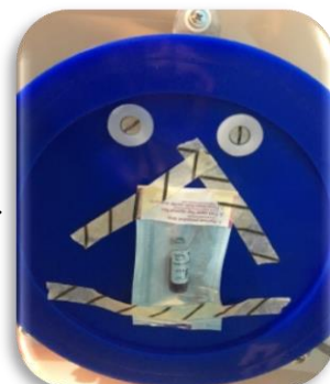
Figura 6. Una vez finalizado el ciclo de esterilización se retiró la ampolleta número 1 de la puerta.
