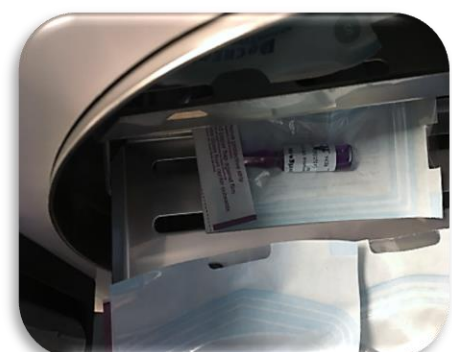
Figura 7. Se retiró la ampolleta número 2 de la parte posterior de la autoclave.
