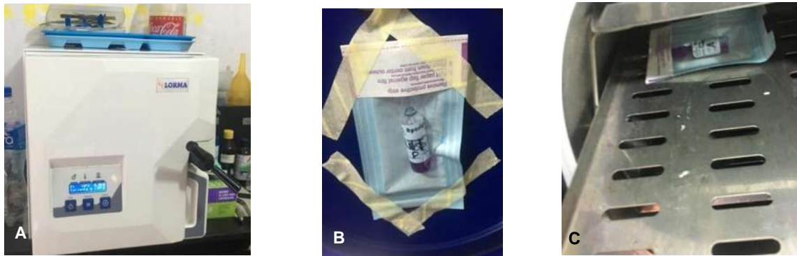
Figura 25. A) Autoclave LORMA, modelo "AV07" a 135°C con 15 minutos de esterilización y 30 min de secado. B) Ampolleta 1 Puerta. C) Ampolleta 2 Atrás.
