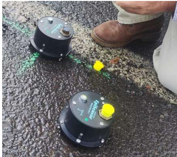
Figura II.3: Acelerómetro triaxial EpiSensor ES-T (fotografía propia)
