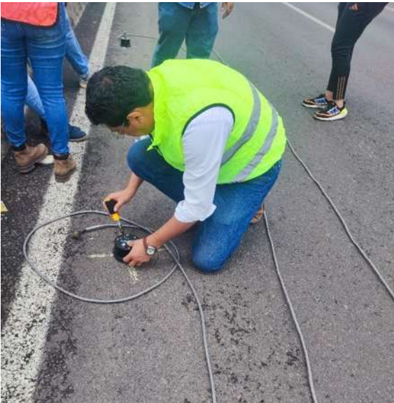
Figura IV.39: Colocación y nivelación de sensores de la primera configuración
