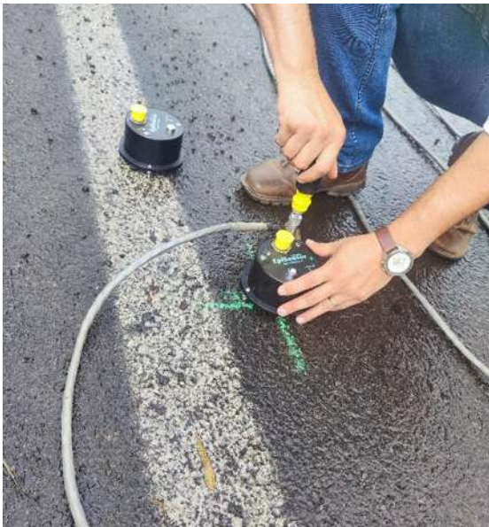
Figura IV.34: Colocación y nivelación de sensores de la primera configuración
