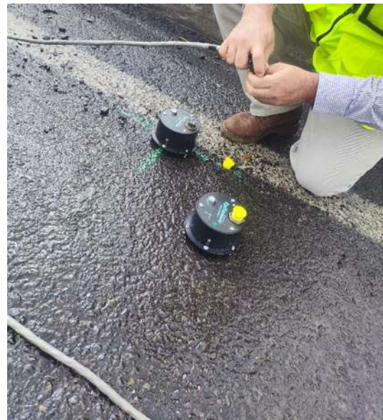
Figura IV.34: Colocación y nivelación de sensores de la primera configuración
