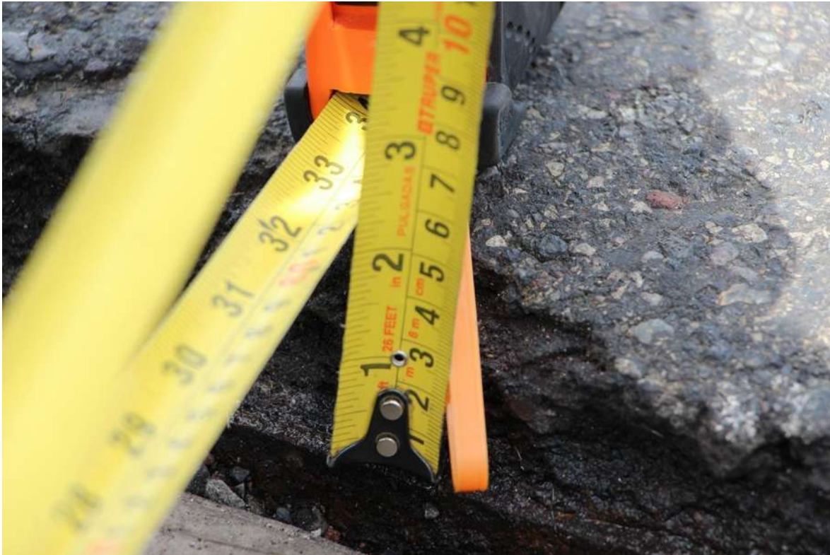
Figura IV.10: Espesor de Reencarpetamiento en puente La Central
