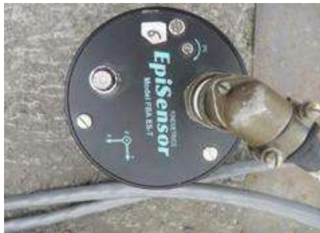
Figura II.2: Acelerómetro triaxial marca Kinometrics, Hernández et al. 2021
