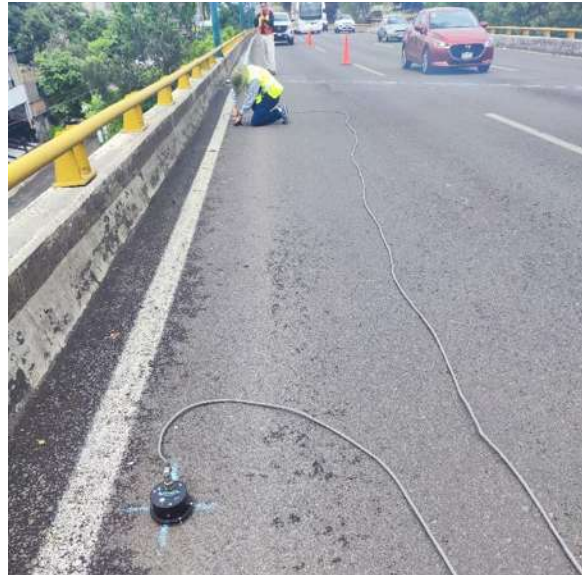
Figura IV.39: Colocación y nivelación de sensores de la primera configuración
