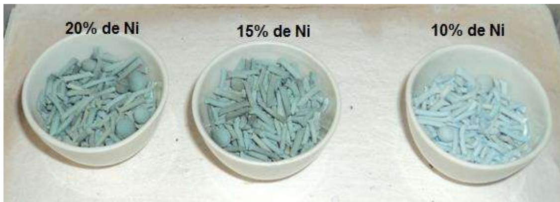
FIGURA IV.4.4. Catalizadores regenerados a 400°C.
