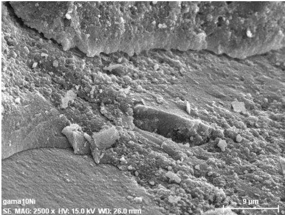
FIGURA VIII.4.4. Micrografía de cilindro extrudado de gama alúmina impregnado con 10% de Ni, acercamiento 2500x.
