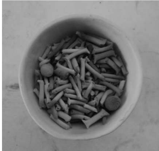
FIGURA IV.4.3. Catalizador de 10% de Ni desactivado.
