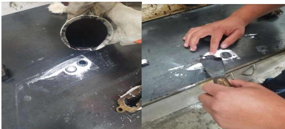
Ilustración 52.- Llenado de muestras y enrasado
