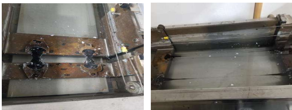
Ilustración 50.- Colocación y puesta en marcha de Ductilómetro
