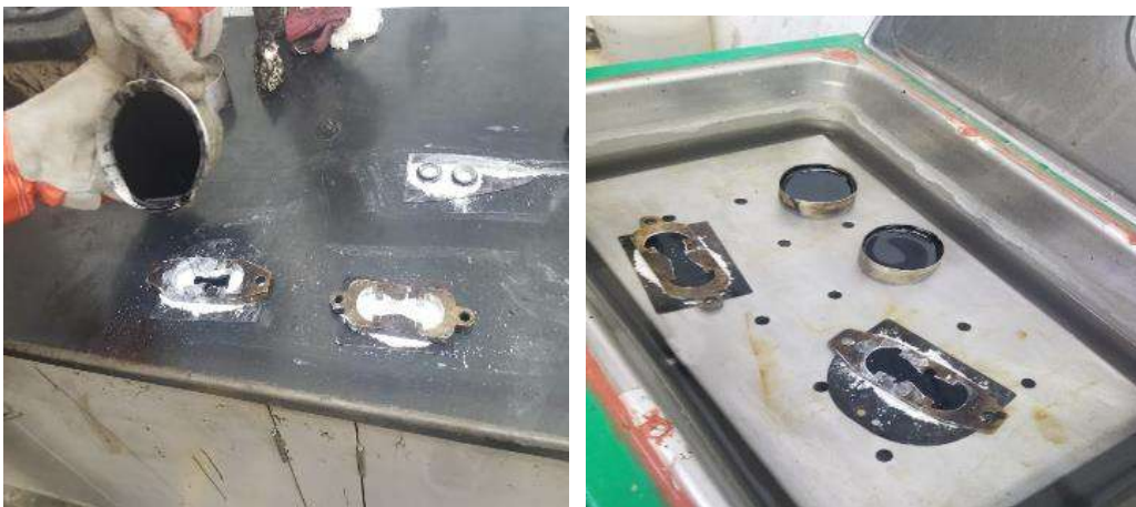
Ilustración 48.- Llenado de briquetas y colocado en baño María
