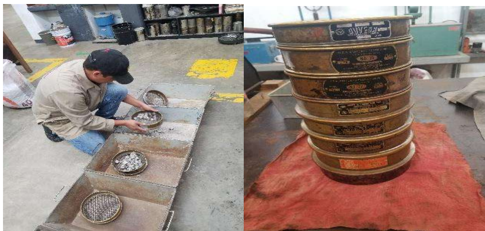
Ilustración 56.- Ejecución de prueba granulometría
