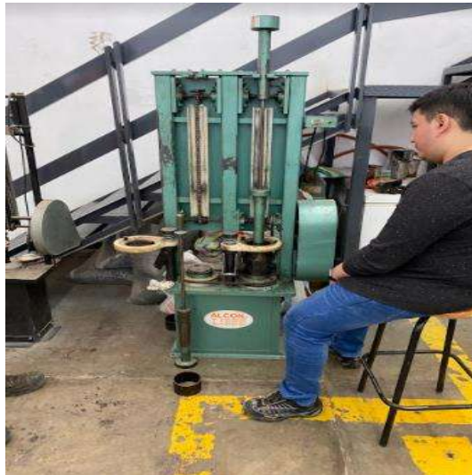
Ilustración 67.- Compactación de pastillas
