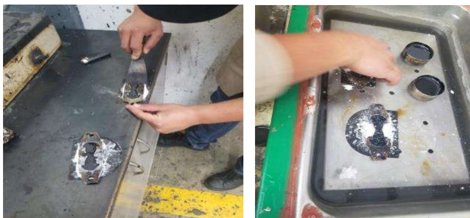
Ilustración 49.- Enrasado de capsulas
