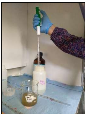
Figura 29 Se toman 5 mL de ácido nítrico y 5 mL de ácido clorhídrico.
