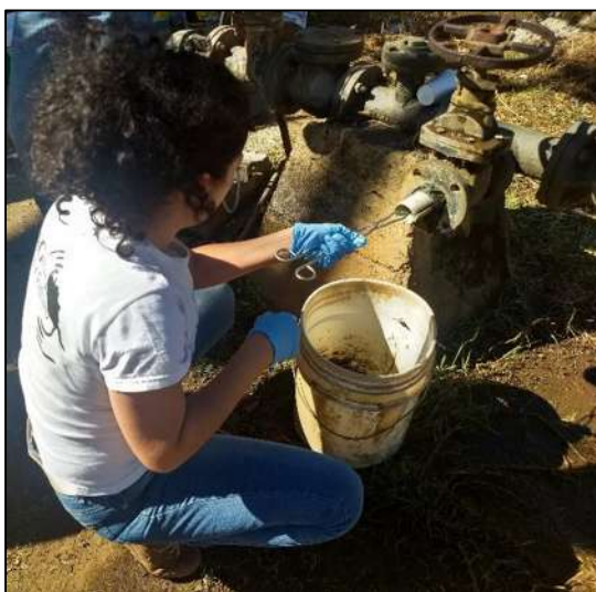
Figura 22. Esterilización del tubo de agua para la toma de muestra.
