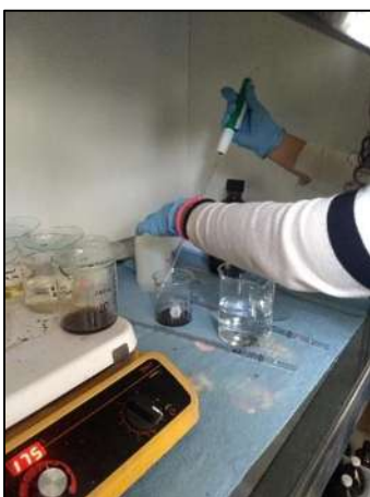
Figura 33. Se coloca la muestra de suelo en un vaso de precipitados y se tapa.
