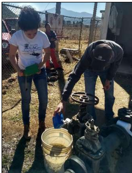
Figura 24. Toma de muestras para la determinación de los parámetros físicos y químicos en laboratorio.
