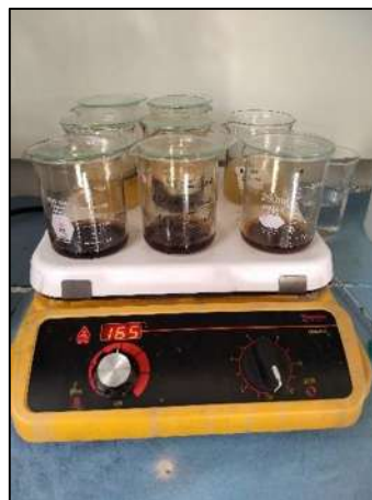
Figura 36. Se coloca sobre una plancha hasta obtener 5 mL.
