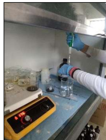
Figura 37. Se adiciona 2 mL de agua destilada y 3 mL de peróxido.
