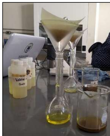
Figura 40. Se filtran los 5 mL hasta su aforo.
