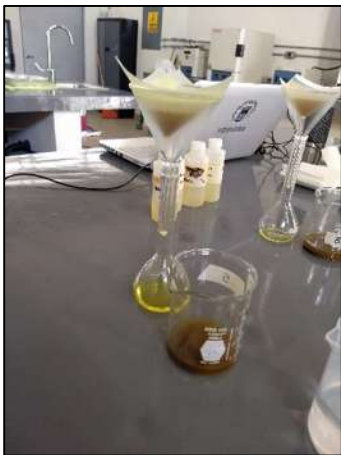
Figura 32. Se filtran los 10 mL hasta su aforo.
