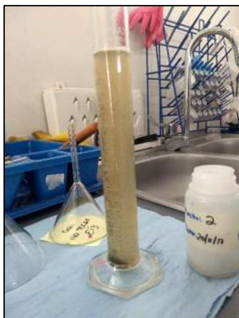
Figura 27. 100 mL de agua residual en probeta.
