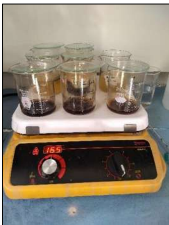
Figura 31. Se coloca sobre una plancha hasta obtener 10 mL.
