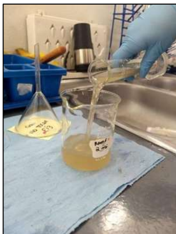
Figura 28. Trasvasar el agua de la probeta a un vaso de precipitados.
