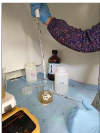
Fi. 30 Se coloca el ácido nítrico lentamente sobre la muestra de agua residual.
