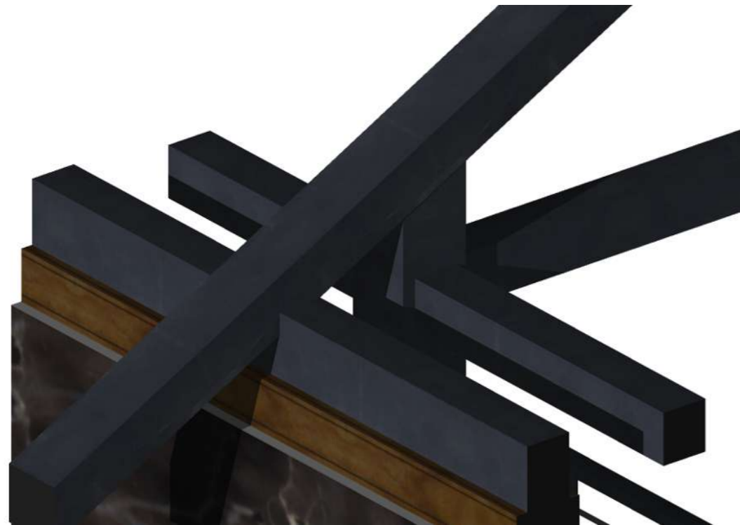
Maqueta virtual, viga de arrastre que va debajo de el perfil metálico.
