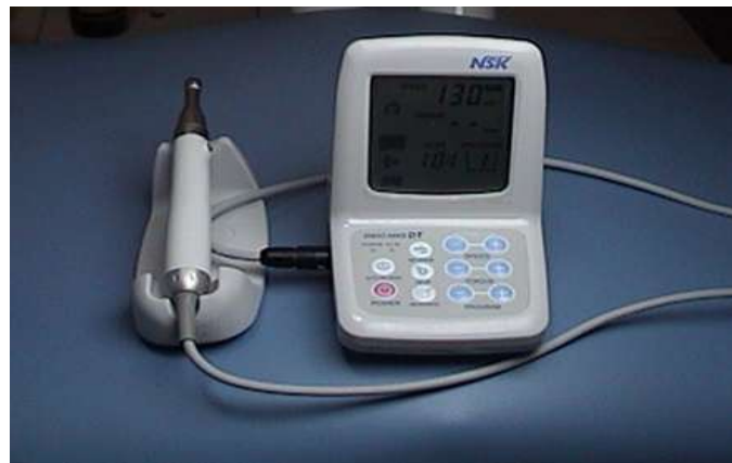
FIGURA 9. Motor eléctrico con control de torque y velocidad utilizado para la instrumentación rotatoria.
