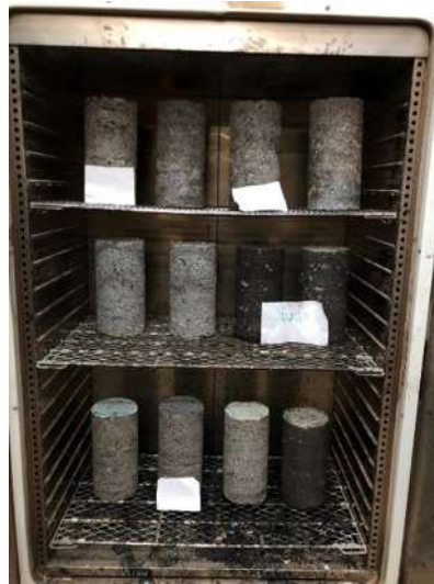
Ilustración 13. Acondicionamiento de especímenes en horno a 40°C para ensaye triaxial.
