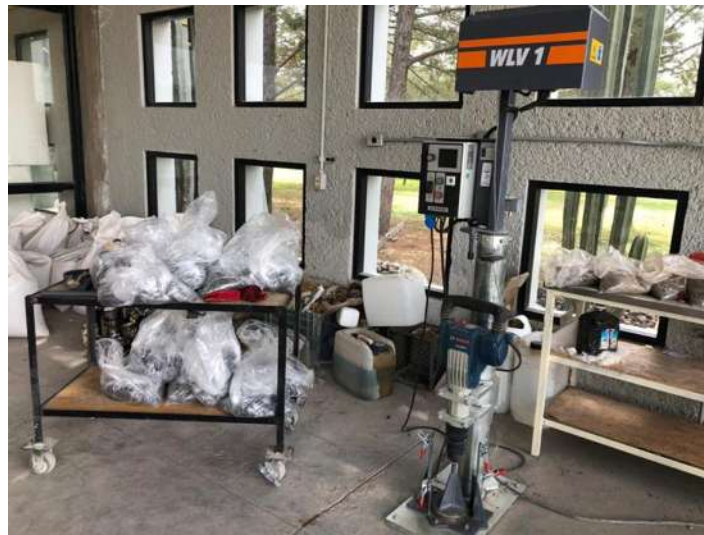
Ilustración 12. Compactador neumático para elaboración de especímenes de ensaye triaxial.
