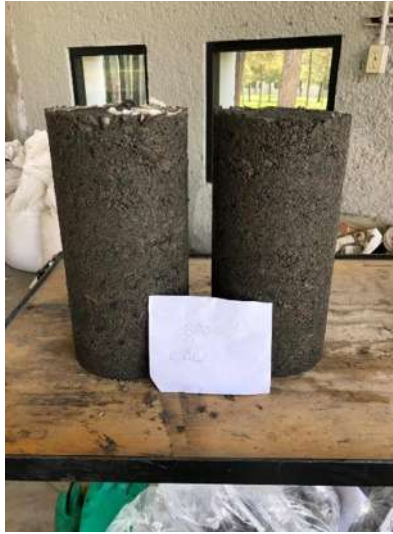
Ilustración 11. Especímenes cilíndricos para ensaye triaxial (150 mm de diámetro y 303 mm de altura).
