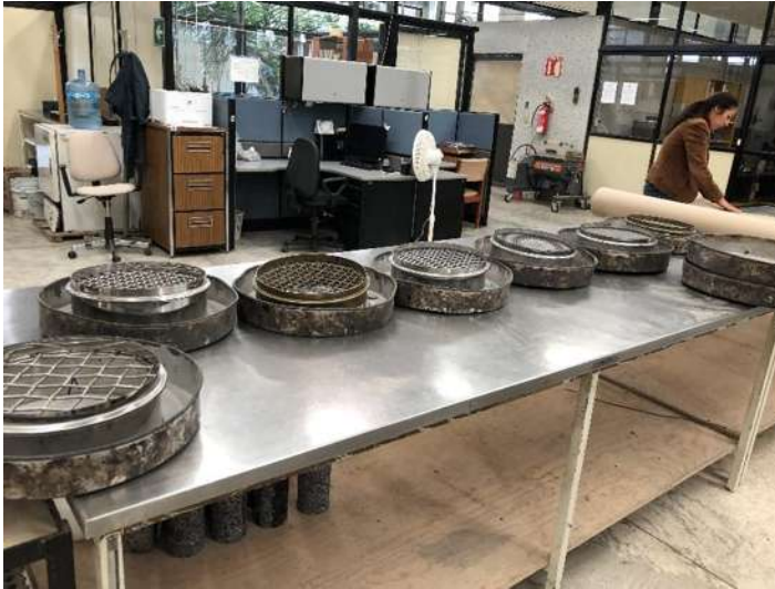
Ilustración 6. Proceso de granulometría del agregado de base.
