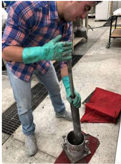
Ilustración 9. Prueba de compactación “Proctor modificada”.
