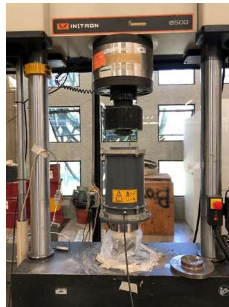
Ilustración 15. Ensaye triaxial a espécimen con confinamiento.
