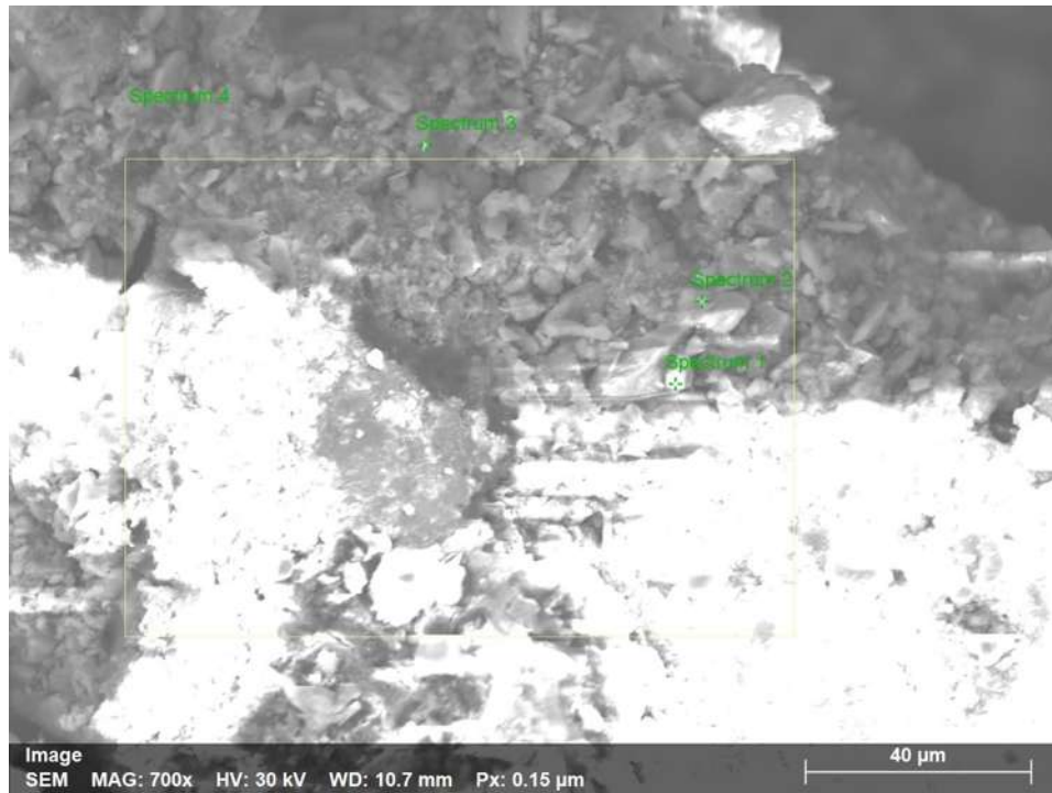
Ilustración 70. Zona seleccionada para el análisis químico de mezcla II con cal.
