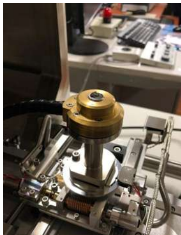
Ilustración 16. Muestra en celda para prueba de microscopía del IMT-SCT, en microscopio Hitachi, modelo S3700N.
