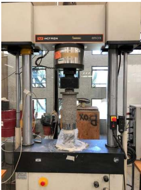
Ilustración 14. Ensaye triaxial a espécimen sin confinamiento.
