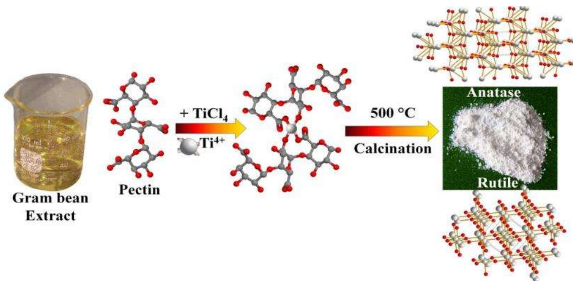
Figura 2.4. Proceso de síntesis para obtener TiO 2 NPs [13].
