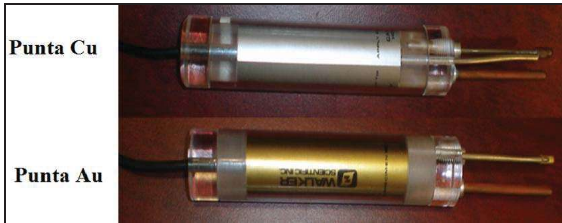
Figura 2.5 Puntas de cobre y oro, para la medición del potencial termoeléctrico.
