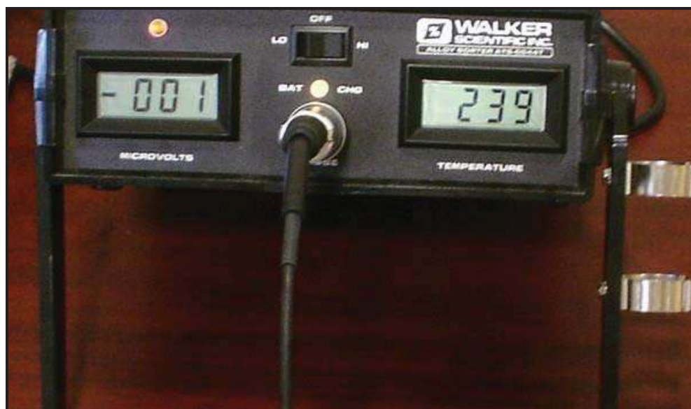
Figura 2.4 Equipo walker scientific alloy sorter ATS-60447.
