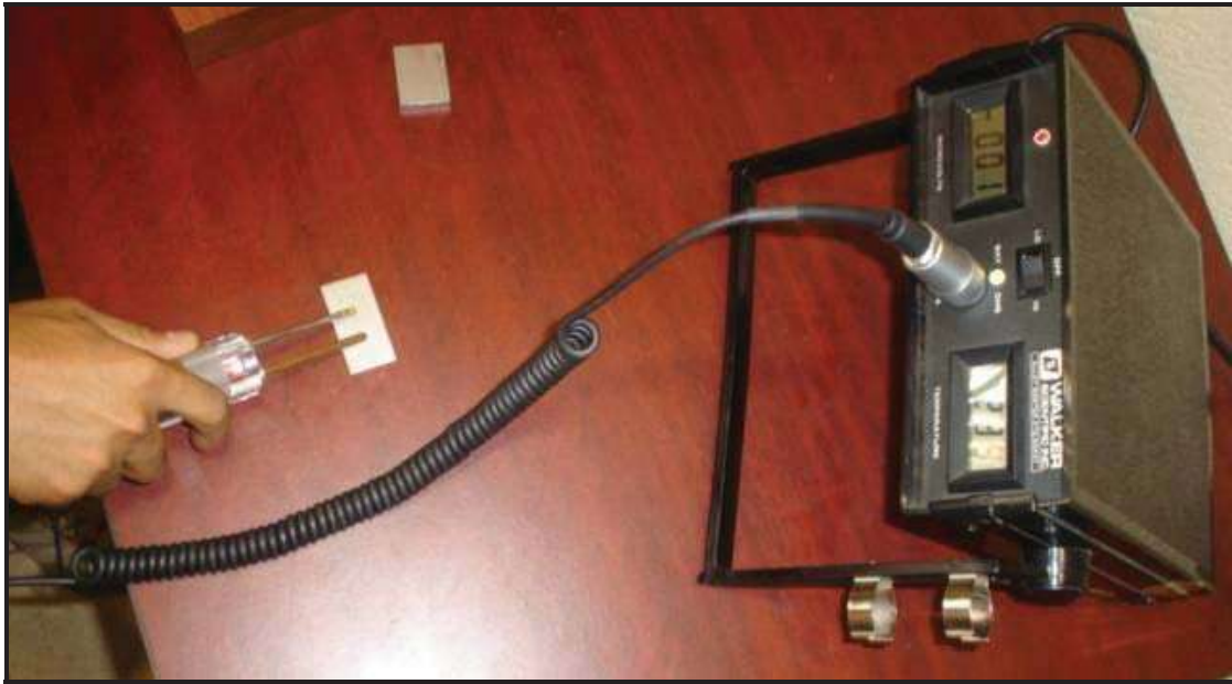
Figura 2.7 Medición del potencial termoelectrico.
