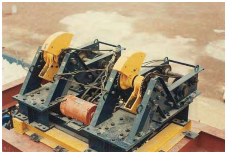
Figura 1.2 Máquina excitadora del Instituto de Ingeniería de la UNAM
