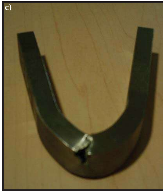
Figura 4.13 Probetas correspondientes al ensayo de doblez. La probeta a) corresponde a la probeta que soportó la carga mínima, la b) corresponde a la carga máxima, y la c), a la probeta que fracturó
