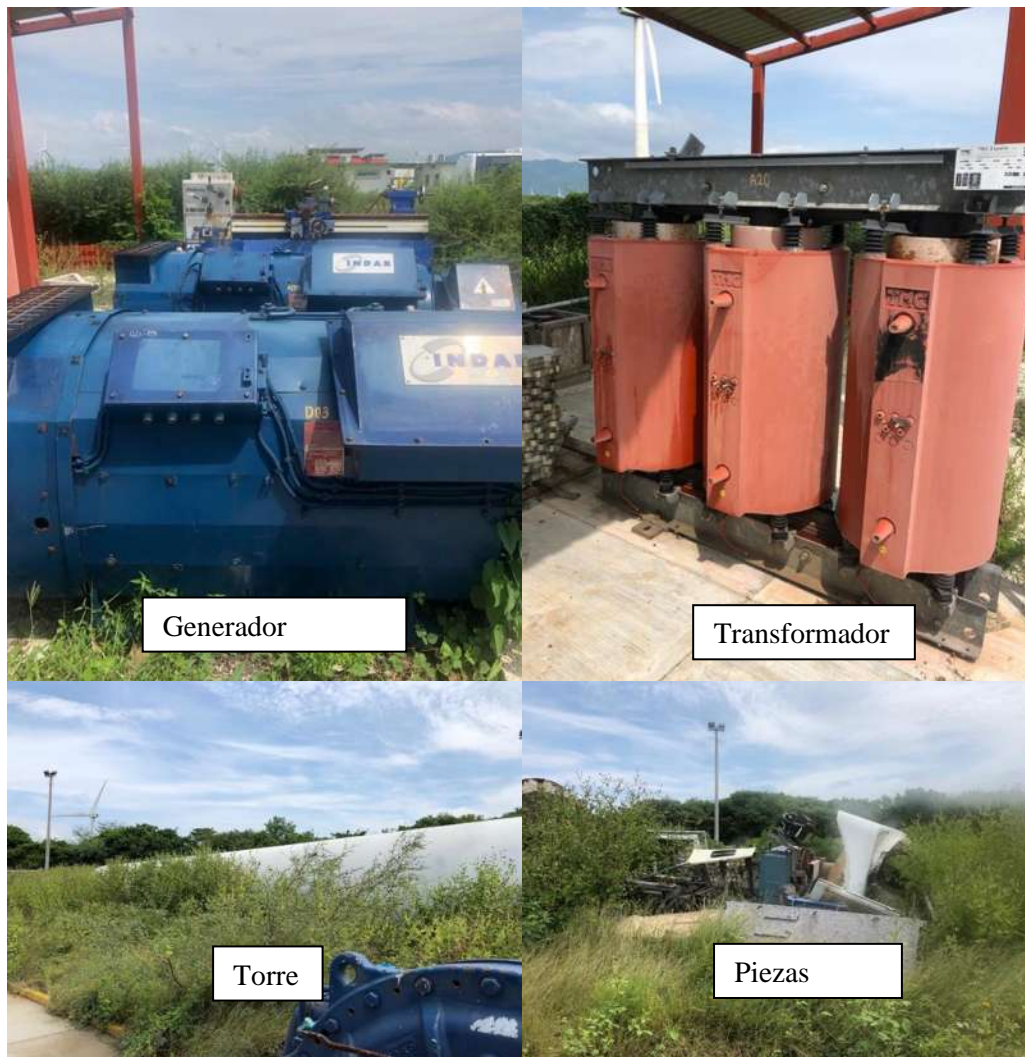
Figura 3.25 Componentes del aerogenerador Vestas V27/225 esperando su correcta disposición
