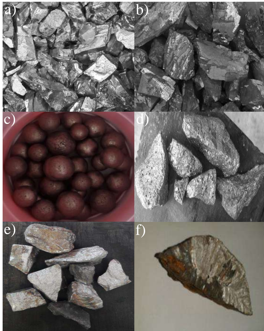
Figura 3.4. Materias primas empleadas para obtener las aleaciones de hierro blanco: a) cromo, b) silicio, c) níquel, d) ferro-vanadio, e) ferro-molibdeno y f) aleación sorel.
