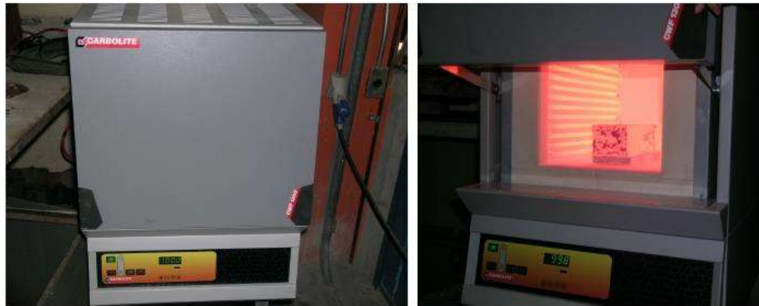
Figura 3.10. Horno de resistencias donde se realizó el tratamiento de desestabilización de los hierros.
