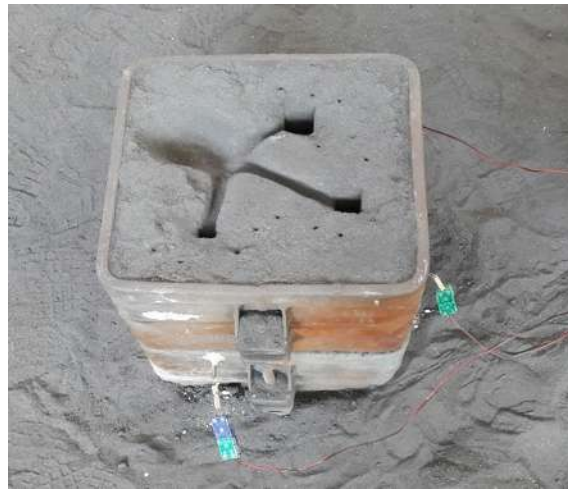
Figura 3.6. Molde de arena en verde con los termopares para monitorear la velocidad de enfriamiento de los diferentes espesores.
