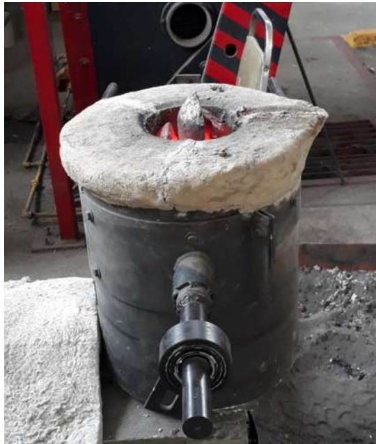
Figura 3.1. Horno de inducción durante la fusión de la aleación base Sorel.
