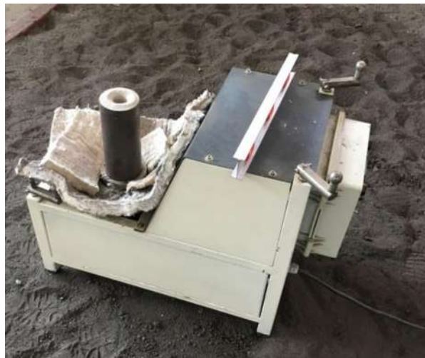
Figura 3.3. Máquina utilizada para solidificación dinámica de una barra redonda de 37 mm de espesor.
