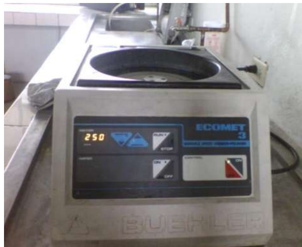
Figura 3.14. Pulidora Marca Buehler modelo Ecomet 3 utilizada para el pulido de las muestras con paño de nylon y pasta de diamante.
